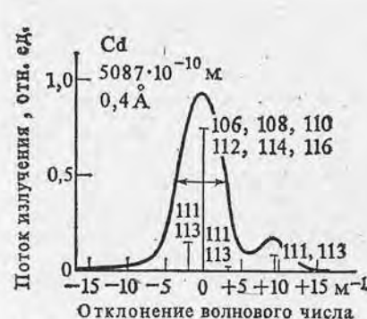
Рис. 12. Профиль линии излучения кадмиевой лампы с естественной смесью изотопов.
