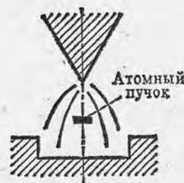
Рис. 32. Форма наконечников для полюсов магнита (теперь устаревшая) для создания неоднородности поля.
