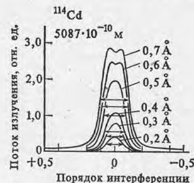
Рис. 13. Профиль линии излучения чистого изотопа {}^{114}\text{Cd} в зависимости от силы тока лампы.
