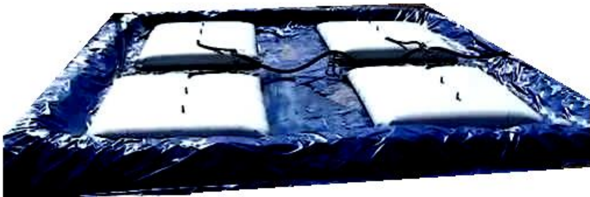
Рис. 3. Група еластичних резервуарів розгорнутих на ґрунті
