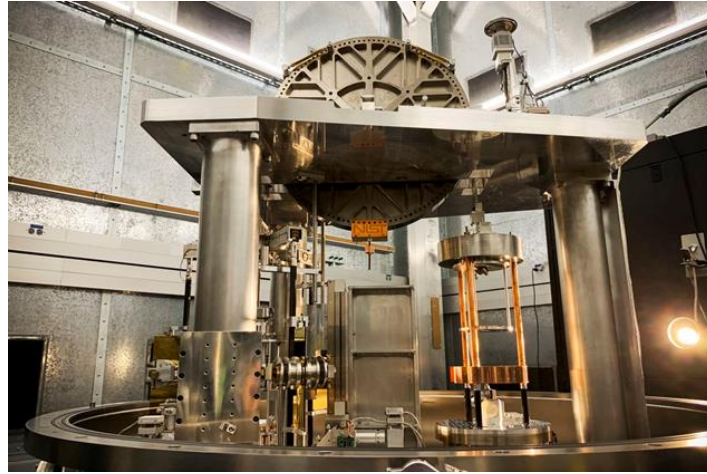
Рис.1. Ваги Kibble — це неймовірно складна красива машина, яка прирівнює механічну силу до електричної
