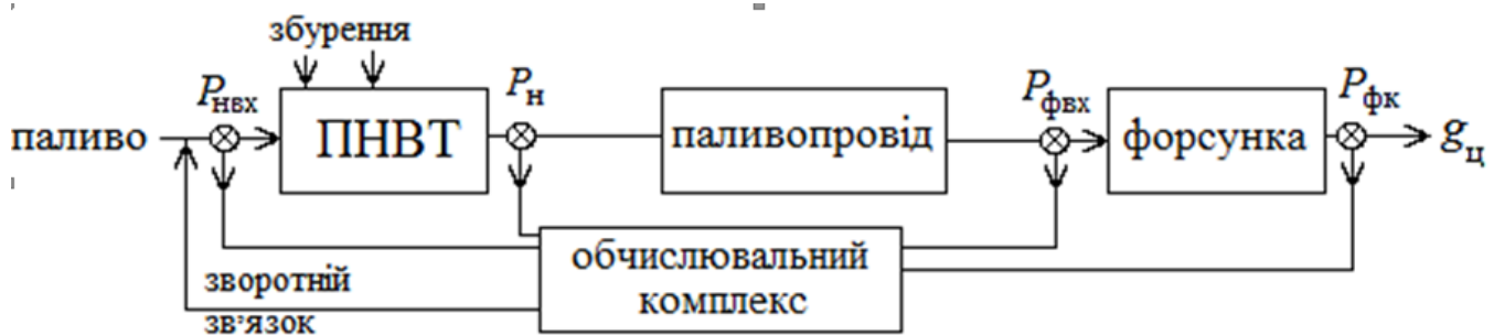
Рис. 1. Система контролю за впорскуванням палива у судновому дизельному двигуні:
