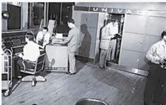
**Первая машина Univac была настолько велика, что в ее корпусе была сделана специальная дверь, через которую инженеры могли проникнуть внутрь, когда компьютер требовал ремонта**
