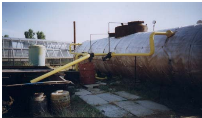
Рис.1. Действующий биоутилизатор органических отходов с использованием солнечной энергии и аккумуляторов тепла на фазопереходных материалах
