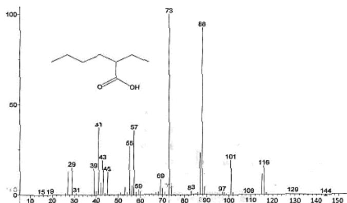
Рис. 3.28. Мас-спектр електронного удару 2-етилгексанової кислоти: [M-CH_3]^+ з m/z 129, [M-C_2H_4]^+ з m/z 116, [M-C_2H_5]^+ з m/z 115, [M-C_3H_7]^+ з m/z 101, [M-C_4H_8]^+ з m/z 88, [C_2H_4COOH]^+ з m/z 73.
