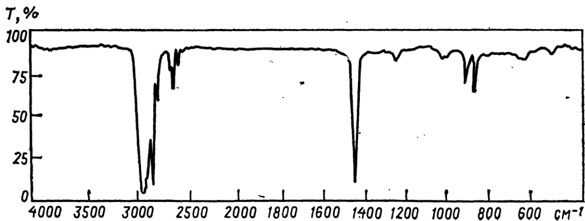
Рис. 2.13. ІЧ-спектр циклогексану (до прикладу 4)
