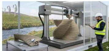
Рисунок 3 – Великогабаритний 3D-принтер друкує складну турбіну в мобільному контейнері
