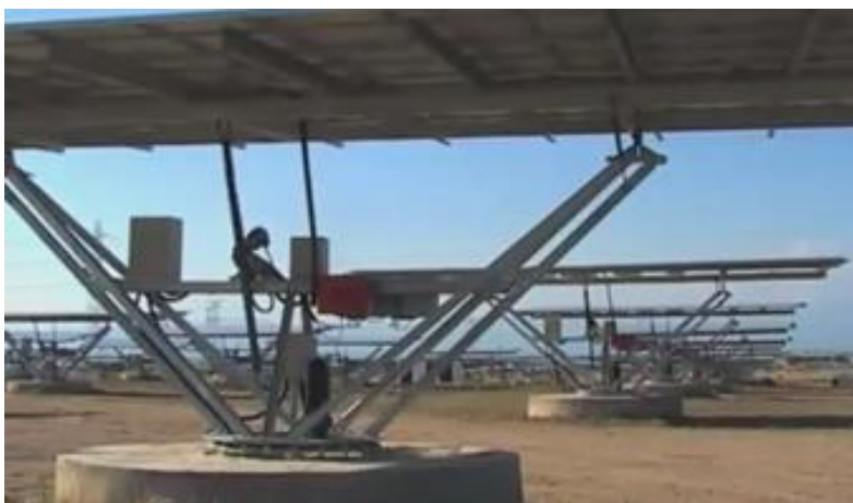
Рисунок 3.7 – Двовісний трекер геліостата
