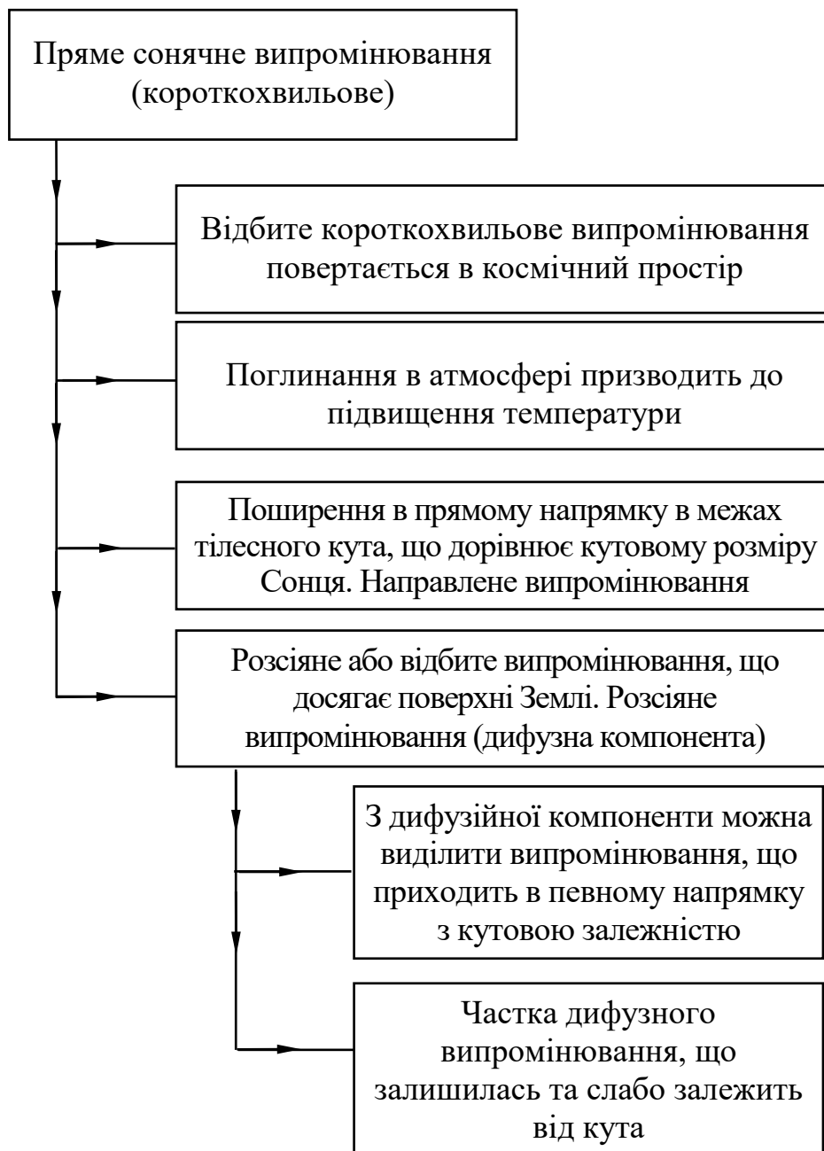
Рисунок 1.5 – Процеси, що супроводжують проходження сонячного випромінювання через атмосферу
