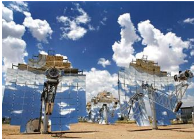
Рисунок 3.4 – Дзеркальні параболічні СЕС з двигуном Стірлінга
