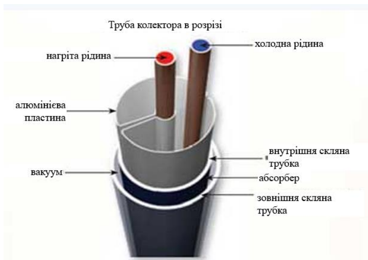
Рисунок 1.14 – Коаксіальна вакуумна трубка із системою U-type
