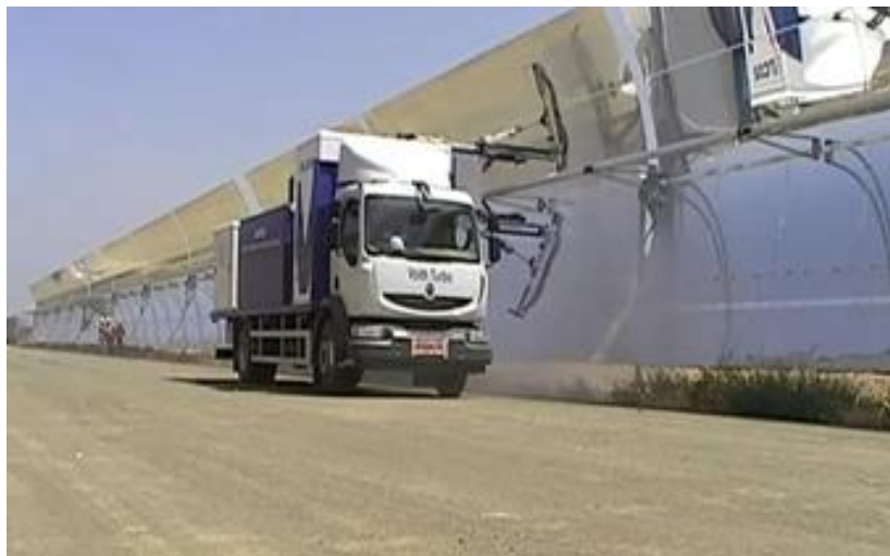
Рисунок 3.5 – Механізоване очищення дзеркал струменем води високого тиску
