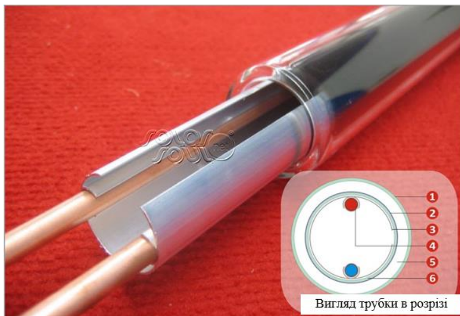
Рисунок 1.17 – Вакуумна коаксіальна трубка з прямоточним тепловим каналом: 1 – зовнішня скляна колба; 2 – високоселективне поглинальне покриття; 3 – алюмінієва вставка; 4 – тепловий канал з теплоносієм; 5 – вакуумний прошарок; 6 – внутрішня скляна колба
