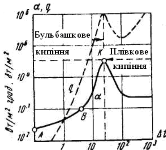
Рис. 2.15. Залежність теплового потоку і коефіцієнта тепловіддачі від температурного напору
