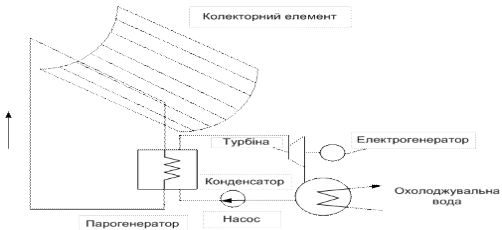
Рис.12.5 – Принципова схема паросилової сонячної електростанції
