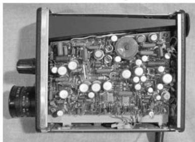
Малогабаритна телевізійна камера "Електроника Н-801-Видео" (1978)
