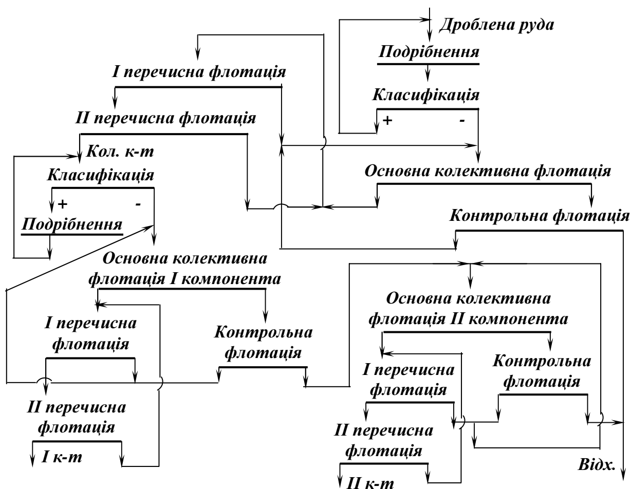
Рис. 3.50. – Схема флотації двокомпонентної руди.
