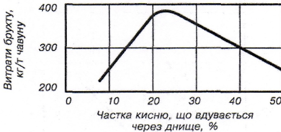
Рис. 4.10. Залежність витрат брухту від частки кисню, що подається через днище
