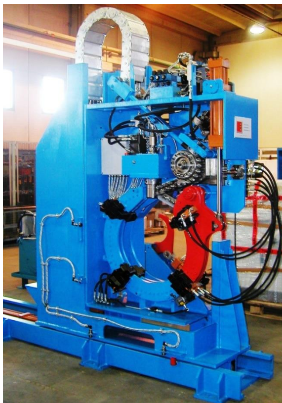
Рисунок 42.7 – Ув’язувальна машина для сортового прокату фірми ATS. [ATS. The powered of new ideas for the iron and steel industry / ATS - Applicazioni Tecnologiche Siderurgiche S.p.A. - http://www.ats.ud.it/index.php ]
