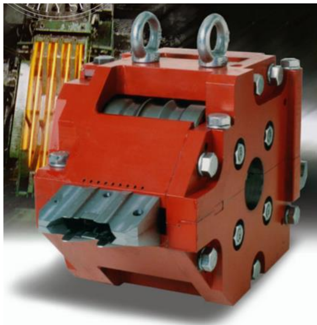
Рисунок 36.11 – Приклади слітінг-арматури для дво- та чотири-ниточного прокатування [Slit Rolling Guides. RTC and CTR / Morgardshammar. – V 299 E. – 16 p. - http://www.danielicorp.com/Slit%20Rolling.pdf ]
