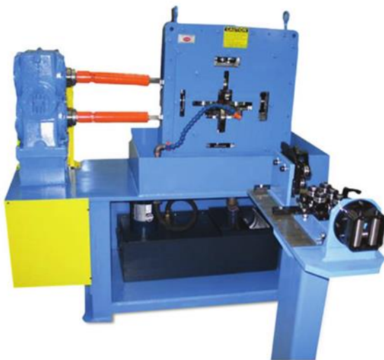
Рисунок 43.8 – Роликові волокни з привідними роликами та лінія протягування фірми Fenn [Turks Head / Fenn. - http://www.fenn-torin.com/wp-content/uploads/Turks-Head.pdf ]
