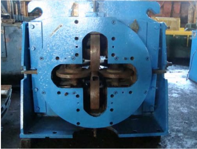
Рисунок 43.7 – Варіанти конструкцій роликів волок [ http://www.realtechno.in/th.html ]
