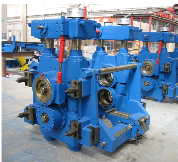
Рисунок 33.13 – Механізм осьового регулювання верхнього валка безстанинної кліті сортового стану [Manufacturer of High Quality Rollin Mill / AVTAR Foundry & Workshop. – India. - http://www.rollingmillmachinery.biz/rolling-mill.html ]
