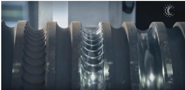
Валки для прокатування арматурних профілів
