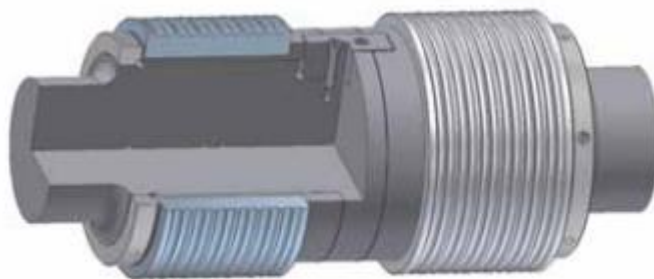
Рисунок 2.6 – Схема валка CIC Combi Roll [13]
