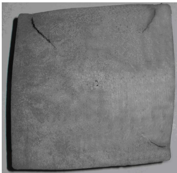
Рисунок 4.7 – Поперечний переріз сортової заготовки з підвищеною ромбічністю й внутрішніми тріщинами
