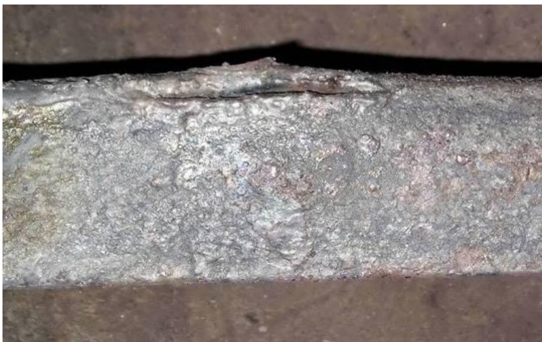
Рисунок 3.38 – Зовнішній вигляд тріщини, що утворилась у сортовій заготовці (переріз 125×125 мм) під кристалізатором
