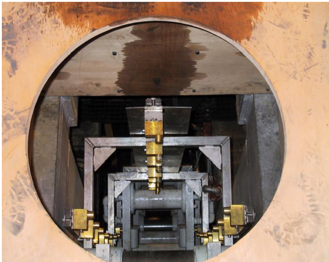
Рисунок 7.9 – Колектор вторинного охолодження
