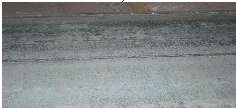
Рисунок 4.8 – Поздовжні поверхневі тріщини: прикутова (а,б) і по середині широкої грані сляба (в)
