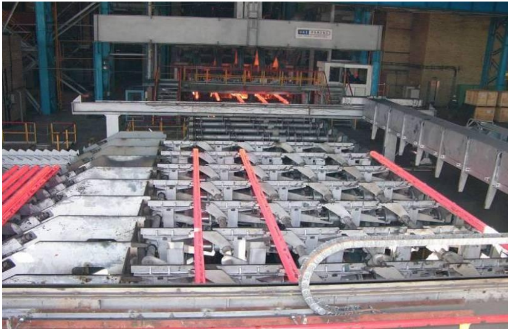
Рисунок 1.7 – Зіштовхувач і холодильник сортової МБЛЗ
