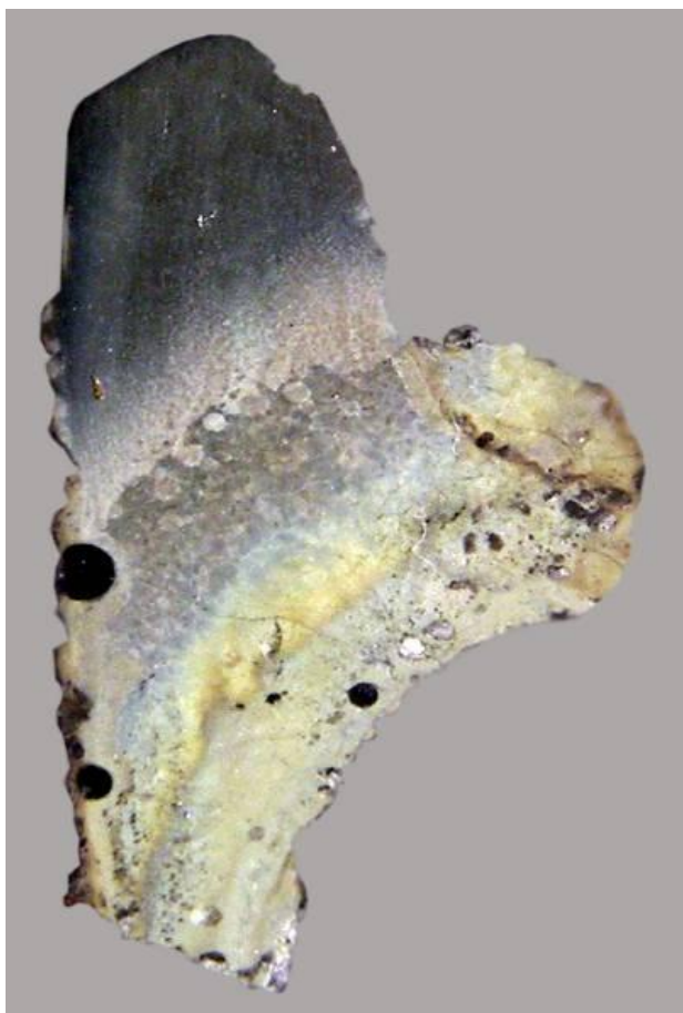
Рисунок 3.47 – Поздовжній розріз шлакового «носика», відібраного із кристалізатора слябової МБЛЗ
