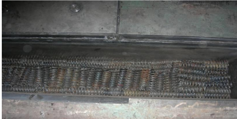
Рисунок 7.12 – Положення затравки в кристалізаторі (за холодильники використані кручені вироби)
