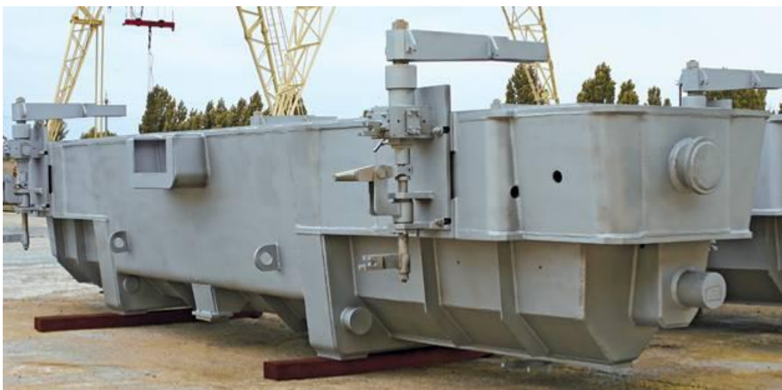
Рисунок 7.2 – Промківш слябової МБЛЗ
