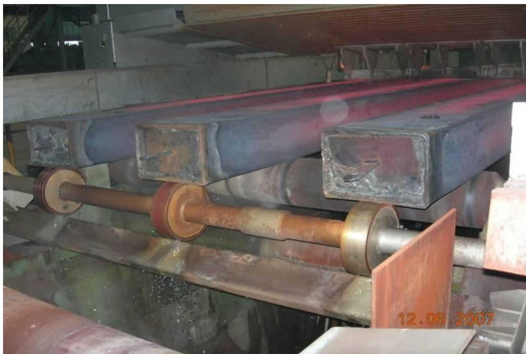
Рисунок 7.17 – Хвостові частини блюмових заготовок з «замороженими» пластинами-холодильниками
