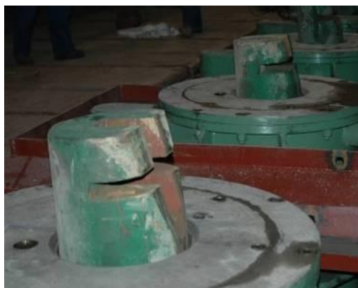
Рисунок 3.77 – Головка затравки для розливання на МБЛЗ круглої заготовки (ліворуч) і усталовлення на неї захисного ковпака (праворуч)
