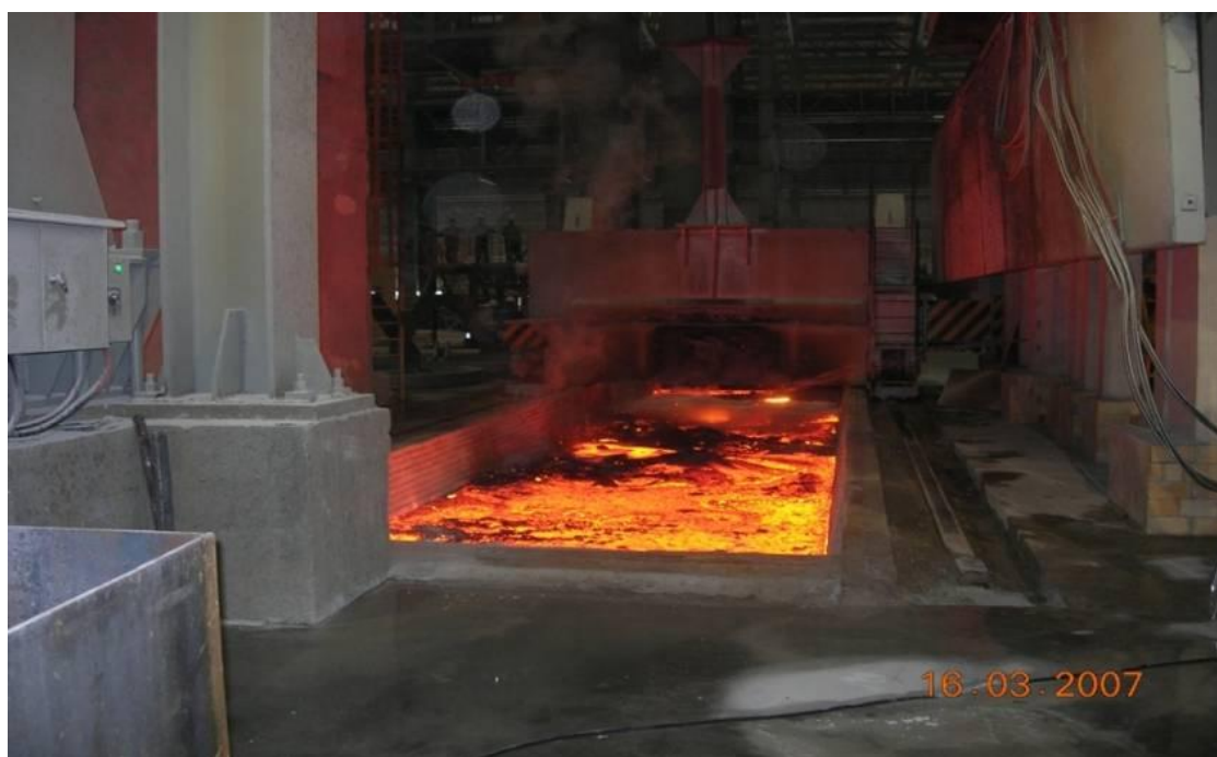
Рисунок 7.22 – Аварійна ємність для зливу рідкої сталі
