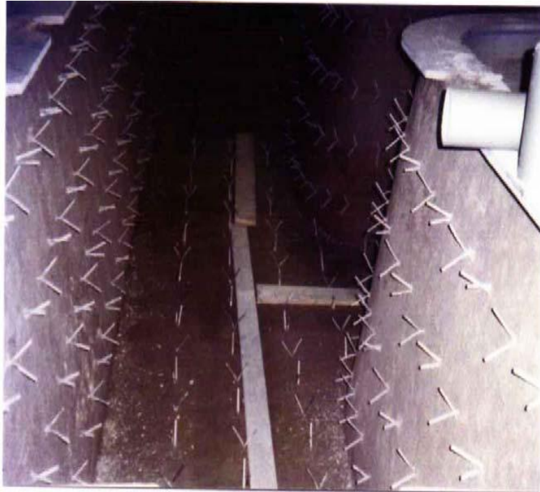
Рисунок 3.20 – Схема розташування анкерів на стінках промковша
