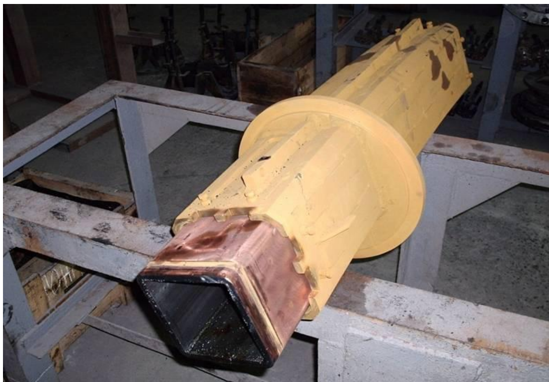
Рисунок 7.6 – Гільза кристалізатора з обичайкою
