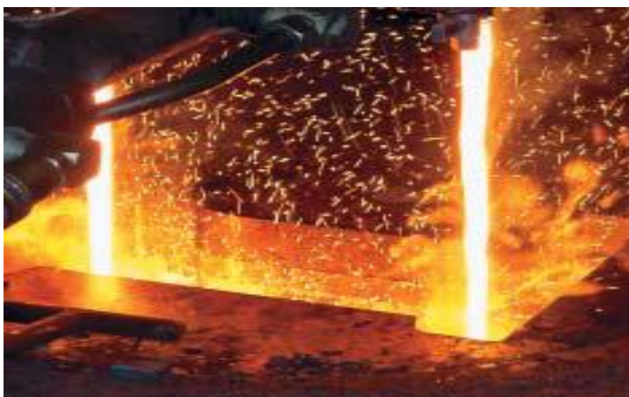
Рисунок 6.10 – Подавання сталі відкритим струменем у кристалізатор фасонної МБЛЗ
