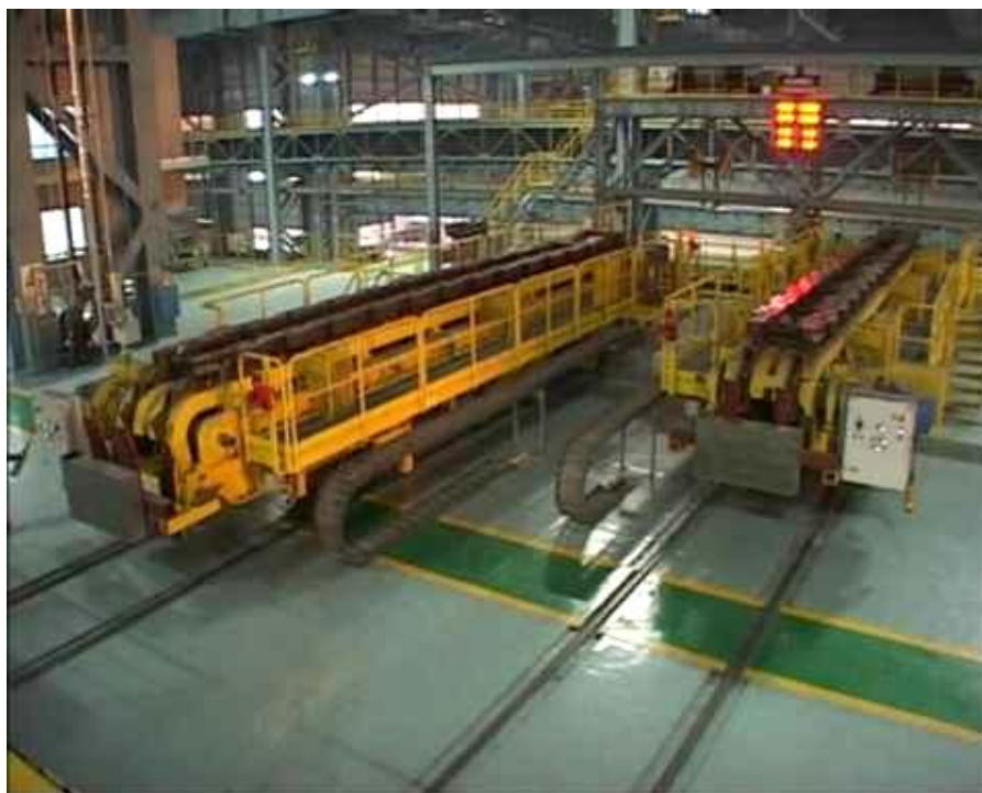
Рисунок 3.81 – Машини для уведення затравки в кристалізатор зверху
