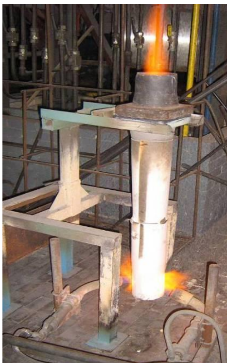
Рисунок 7.5 – Нагрівання заглибних стаканів перед розливанням
