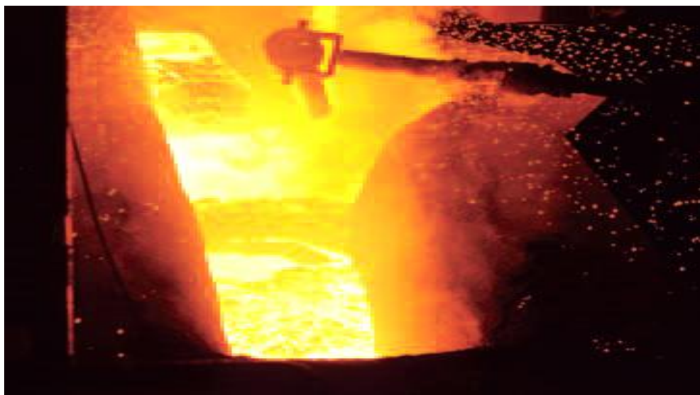
Рисунок 3.8 – Загальний вид промковша сортової МБЛЗ, наповненого рідкою сталлю
