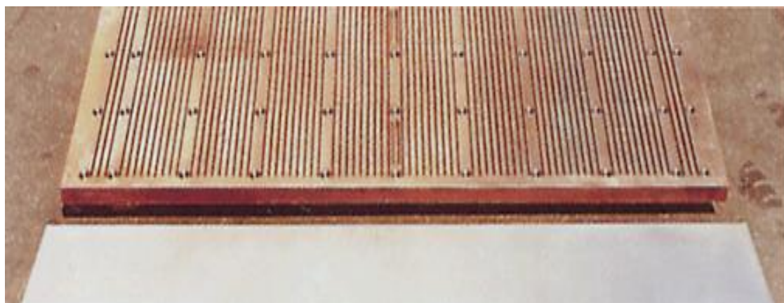
Рисунок 3.59 – Мідна панель широкої грані слябового кристалізатора з каналами водяного охолодження
