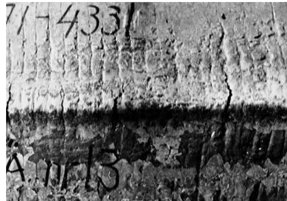
Рисунок 4.9 – Поперечні поверхневі тріщини на грані сортової заготовки (а) і сляба (б,в), а також на кутових ділянках (г,д,е)
