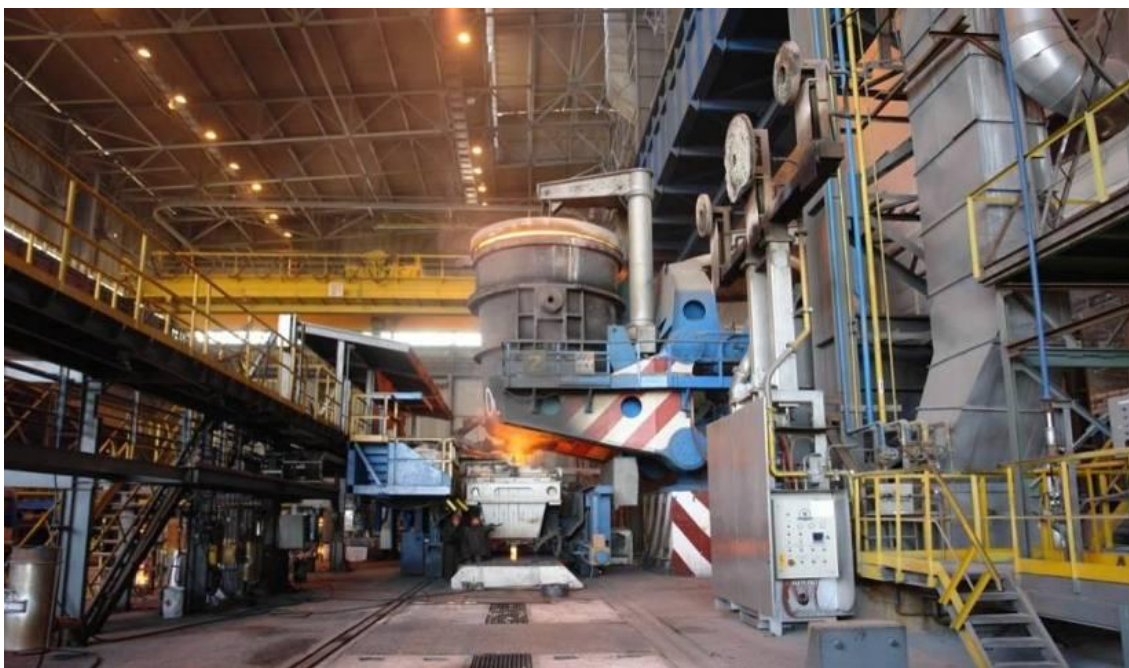
Рисунок 7.21 – Розливальний майданчик МБЛЗ
