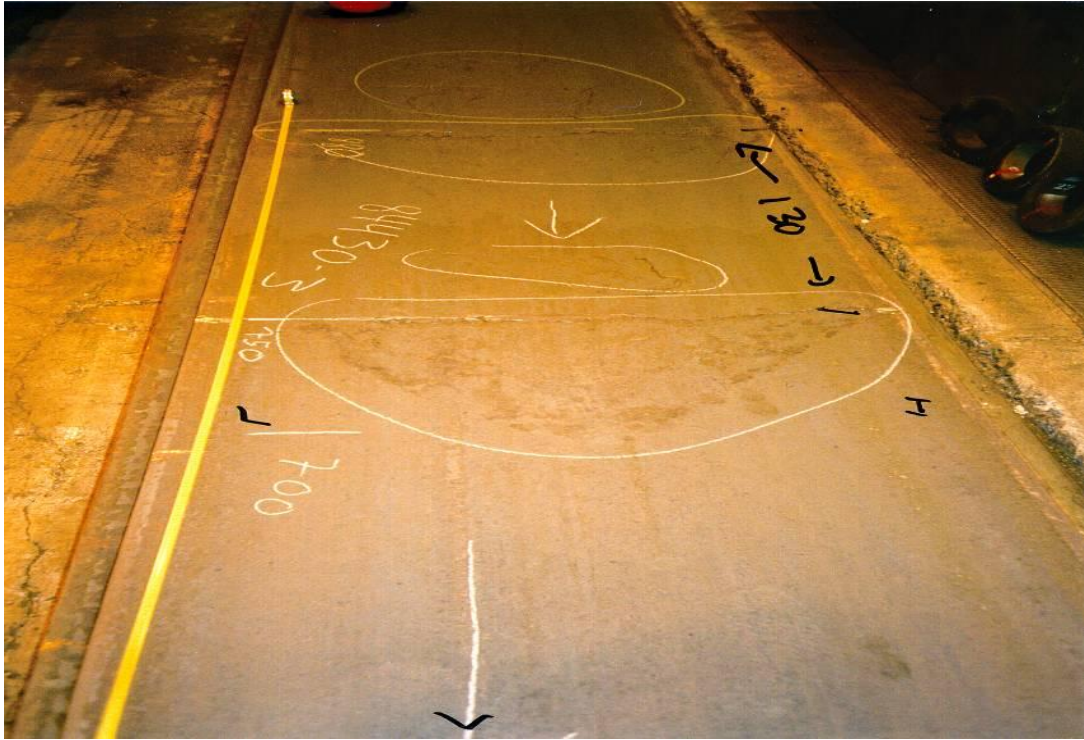
Рисунок 5.10 – Фотографія поверхні сляба з явно вираженим поверхневим дефектом, пов'язаним з проривом скоринки в кристалізаторі
