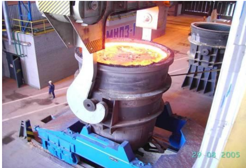
Рисунок 3.1 – Установка ковша з рідкою сталлю на сталевоз
