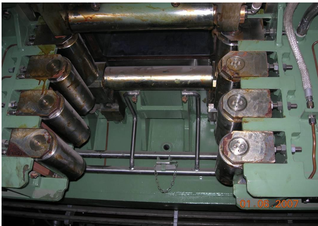
Рисунок 3.58 – Схема розташування підтримувальних роликів під кристалізатором блюмової МБЛЗ
