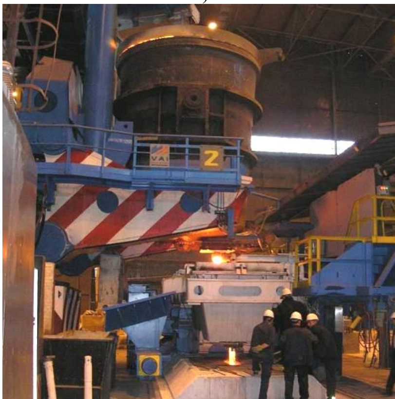
Рисунок 7.13 – Подавання сталерозливного ковша у відділення МБЛЗ (а) і встановлення його на підйомно-поворотному стенді (б)
