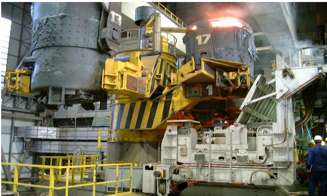
Рисунок 7.16 – Заміна відпрацьованого сталерозливного ковша на новий
