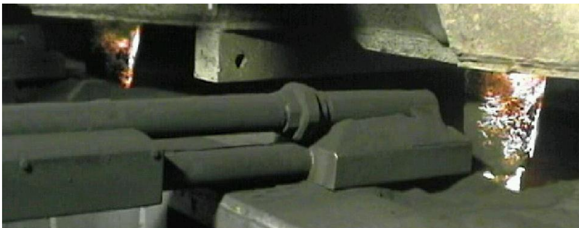
Рисунок 3.52 – Пристосування для автоматичного подавання ШУС у кристалізатор
