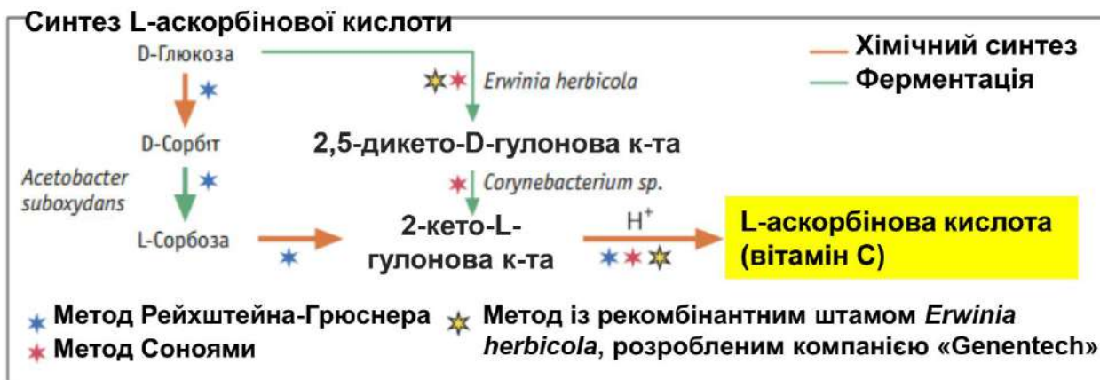
Рис. 2.5. Порівняння трьох методів синтезу L-аскорбінової кислоти. Пояснення в тексті. Адаптовано з [77]
