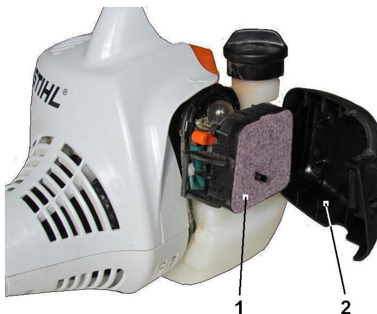
Рис. 2.14. Установка фільтра повітряного в корпус після чистки
