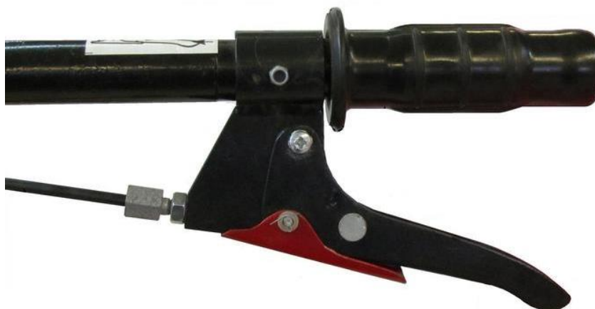
Рис. 4.10. Важіль керування муфтою зчеплення (зчеплення увімкнено)
