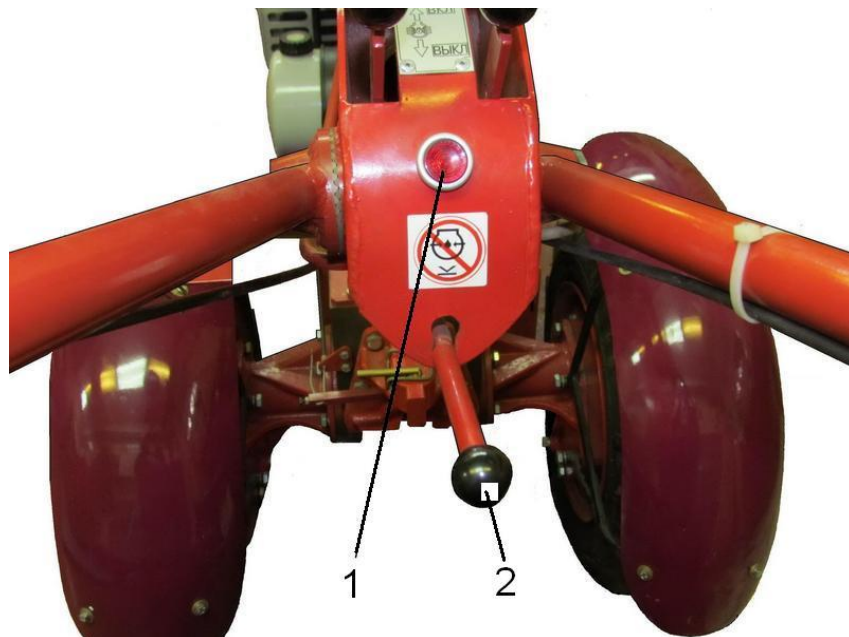
Рис. 1.5. Тяга механізму блокування диференціала
