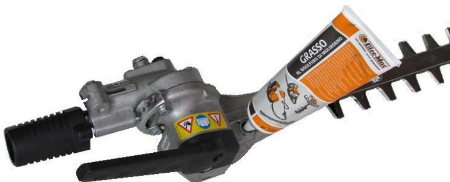
Рис. 4.3. Мащення корпуса передачі ріжучого інструмента мастилом трансмісійним
