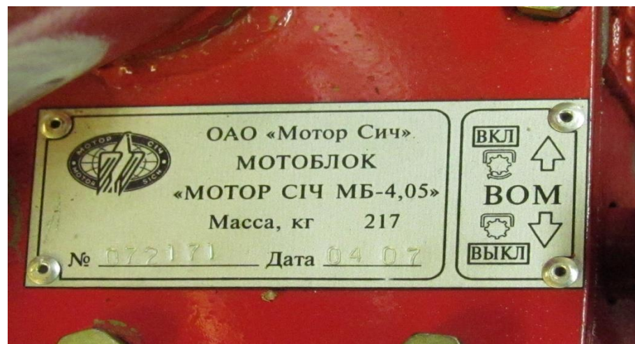
Рис. 1.7. Схема вмикання вала відбору потужності
