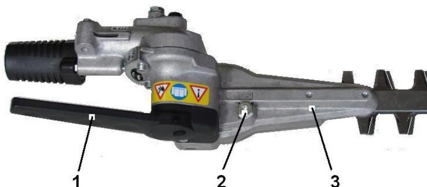
Рис. 4.2. Місце мащення передачі ріжучого ножа
