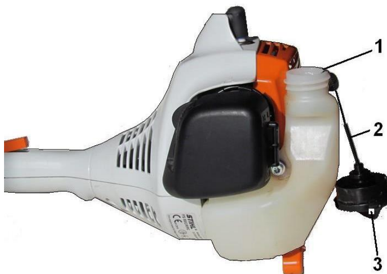
Рис. 2.5. Підготовка двигуна до заправки паливною сумішшю
