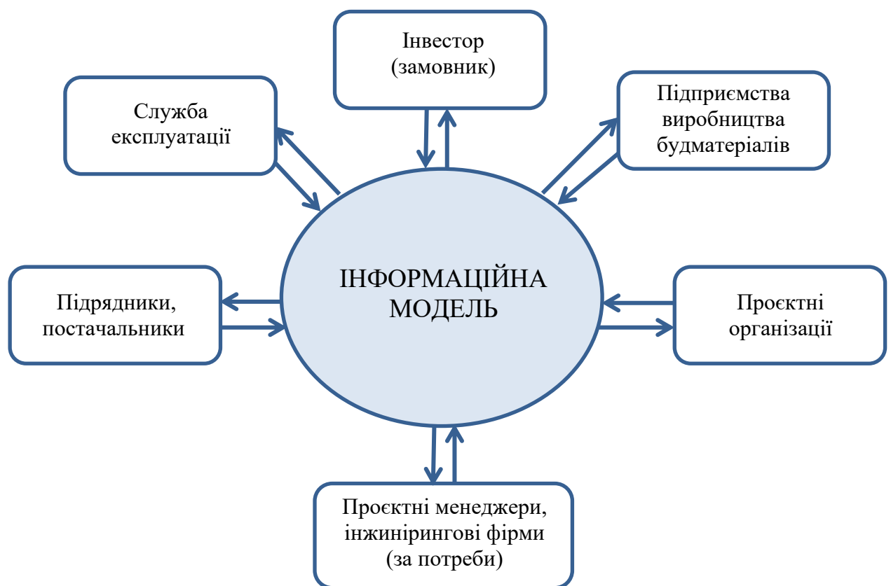
Рис. 3.24 Схема взаємодії учасників проєкту при застосуванні BIM
