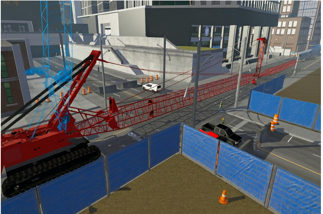
Рис. 7.2 Приклад застосування VR для тренажерів. Американська CM Labs представила віртуальний тренажер для кранівників. Він дає молодим робітникам можливість познайомитися з машинами, перш ніж спробувати свої сили у реальних умовах. Симулятор отримав схвалення Департаменту будівництва Нью-Йорка
