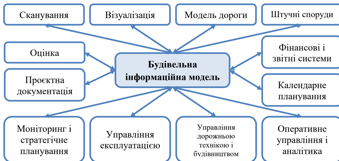
Рис. 3.23 Можливості будівельного інформаційного моделювання (ВІМ). Модель дороги – модель будь-якого об'єкта (модель дороги – приклад)
