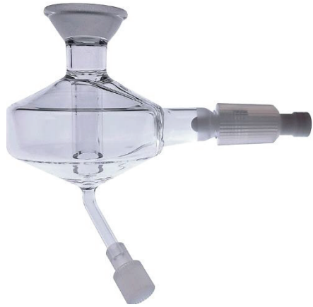
Рис. 1.4. Розпилювальна камера циклонного типу
