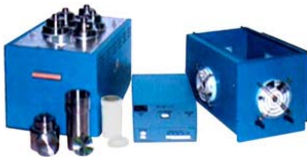
Рисунок 2.1 – Аналітичні модулі автоклавної пробоподготовки з резистивним нагріванням МКП-04 і МКП-05
