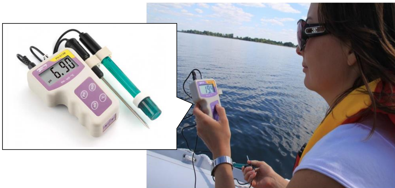
Рисунок 2.3. Прилад експрес-тестування комплексних фізико-хімічних параметрів води PH/PKL-013M
