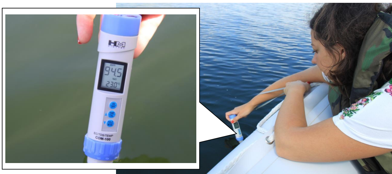
Рисунок 2.2. Прилад експрес-тестування комплексних фізико-хімічних параметрів води COM-100
