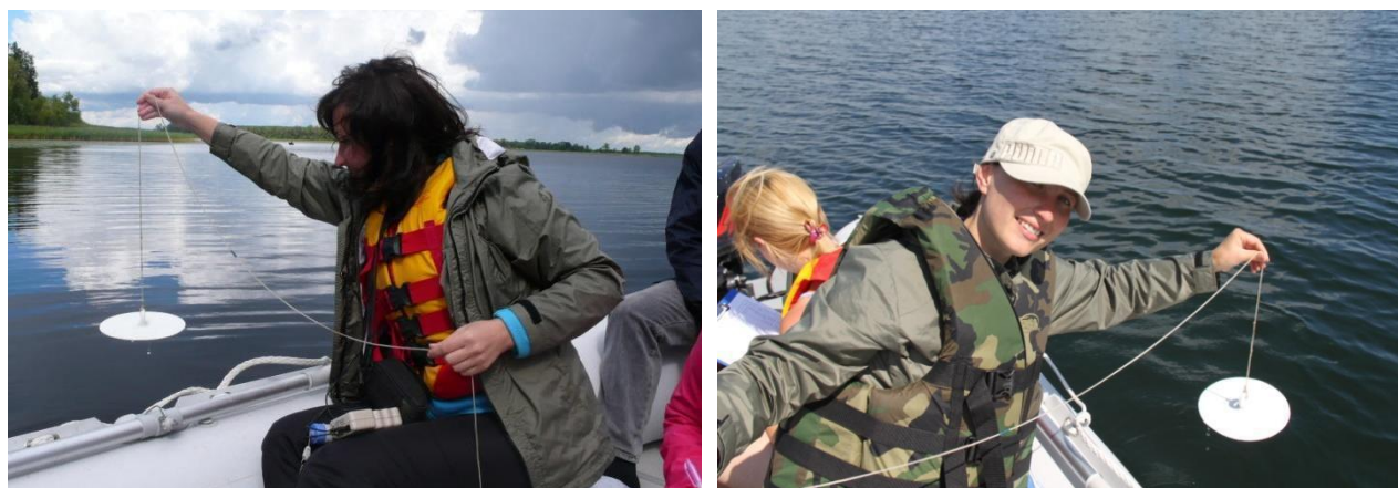
Рисунок 2.4. Визначення прозорості води диском Секкі
