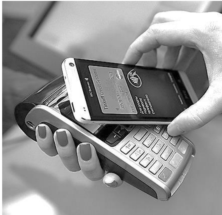
Рисунок 9.4 – Використання пристрою NFC в режимі емуляції карти [2]
