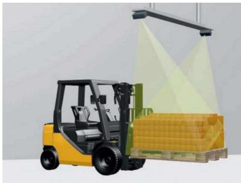
Рисунок 4.5 – Вимір об'єму вантажу за допомогою ToF-камер безконтактним методом [3]
