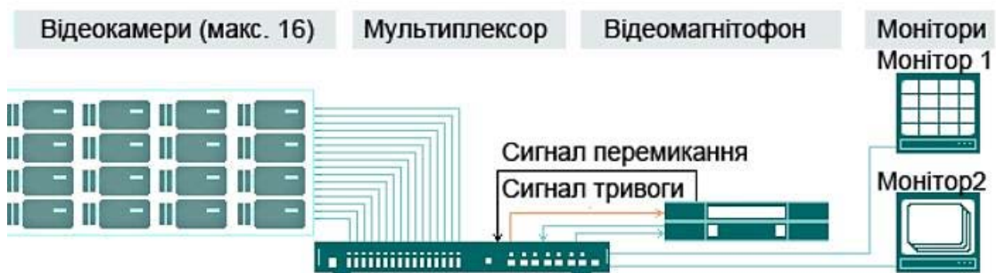
Рисунок 10.10 – Узагальнена структурна схема професійної ч/б системи відеоспостереження [14]
