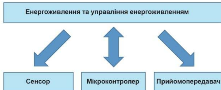
Рисунок 15.5 – Типова структура сенсора з безпроводовим зв'язком
