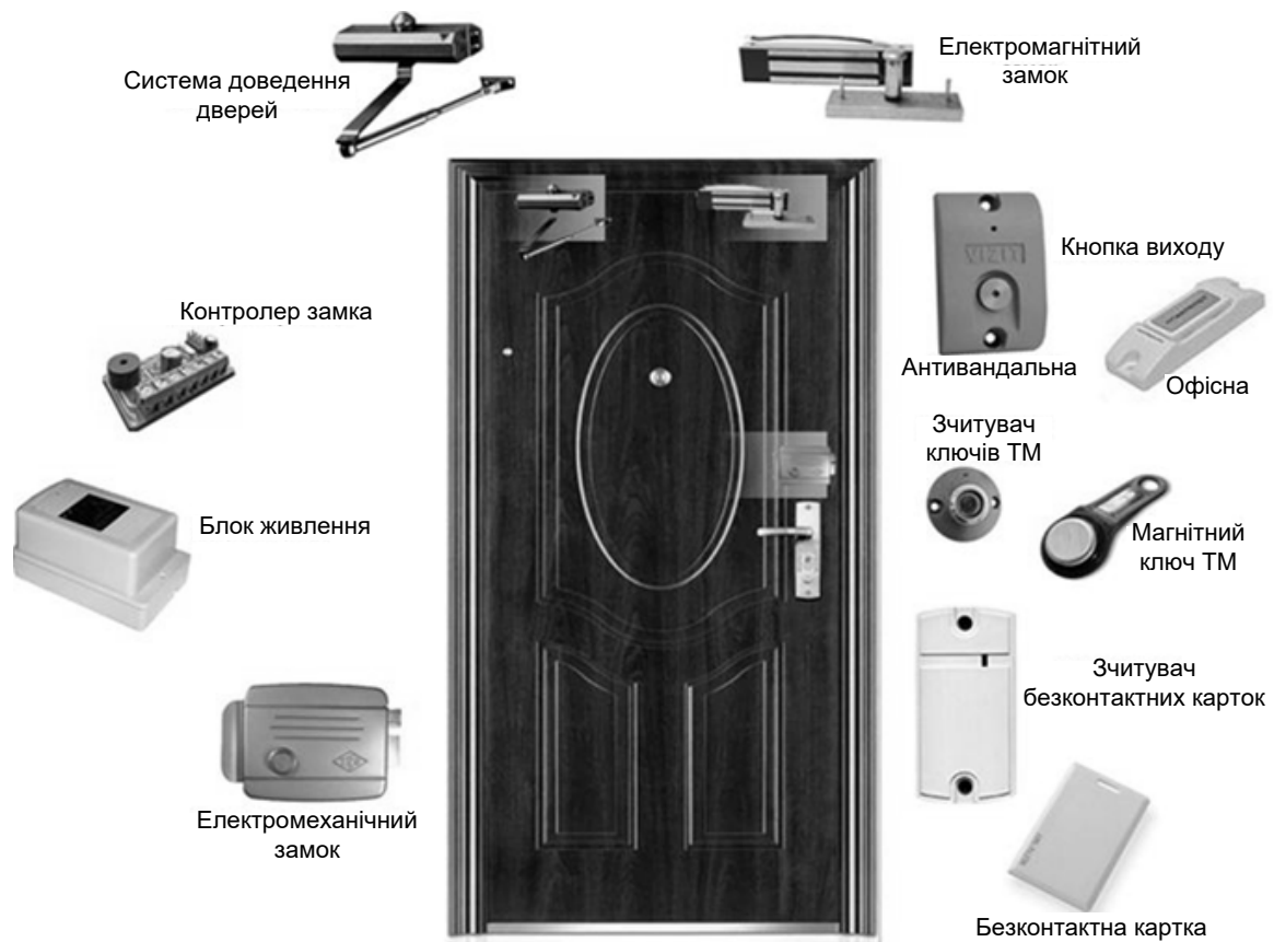
Рисунок 7.18 – Складові елементи системи контролю і управління доступом [19]
