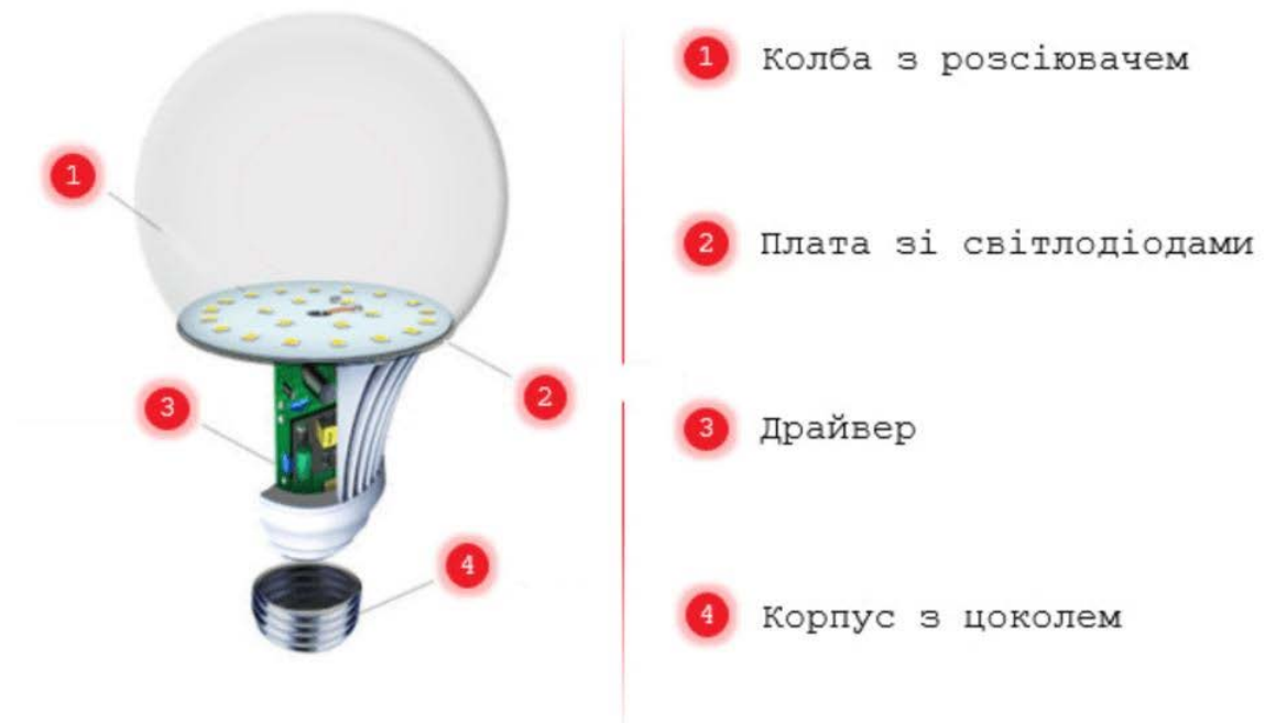
Рисунок 6.16 – Конструкція світлодіодної лампи [15]
