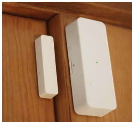
Рисунок 5.17 – Приклад встановлення датчика на дверях розумного будинку [19]
