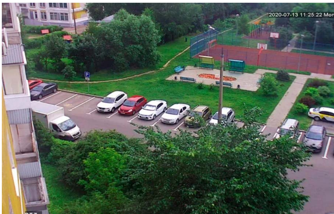
Рисунок 11.1 – Зображення об'єкту при використанні об'єктиву з фокусною відстанню 2,8 мм, кут огляду по діагоналі 102 градуса [3]
