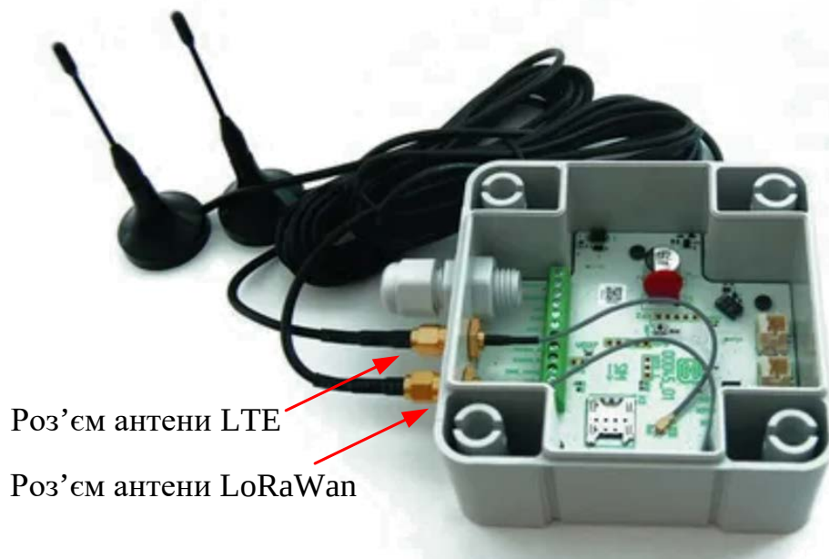
Рисунок 16.5 – Зовнішній вигляд модема Вега SH-2 зі знятою кришкою і підключеними антенами [8]
