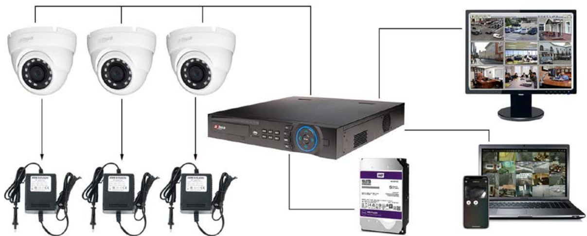
Рисунок 10.8 – Склад простої системи відеоспостереження [13]
