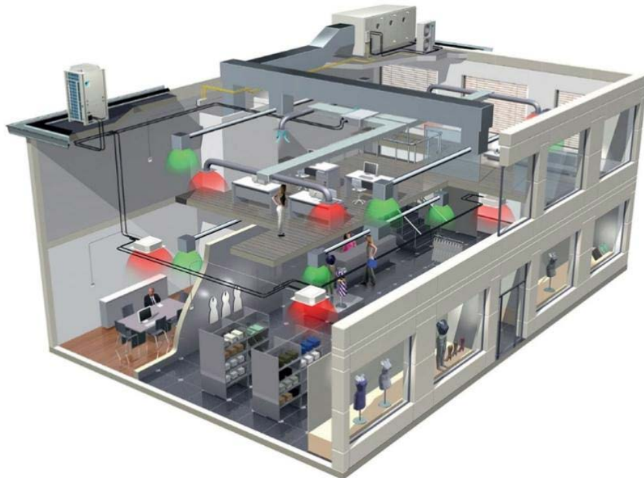
Рисунок 18.3 – Приклад системи чиллер/фанкойл у БЦ [11]
