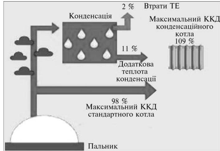
Рис. 5.4.2. Порівняння принципу роботи стандартного і конденсаційного котлів
