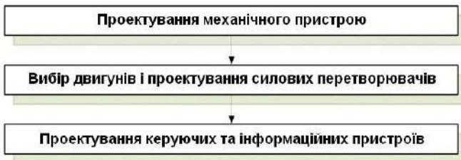
Рисунок 4.4 – Традиційний алгоритм проектування
