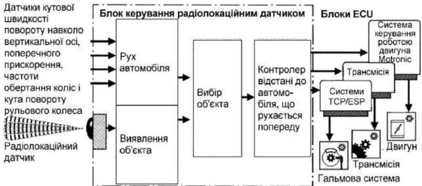
Рисунок 12.8 – Основна структура керування системою ACC
