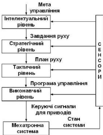
Рисунок 6.18 – Ієрархія керування в мехатронних системах
