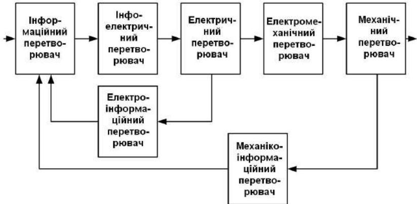
Рисунок 4.8 – Функціональна модель мехатронного модуля
