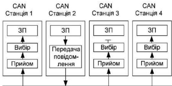
Рисунок 14.18 – Послідовна передача даних з використанням контролера CAN
