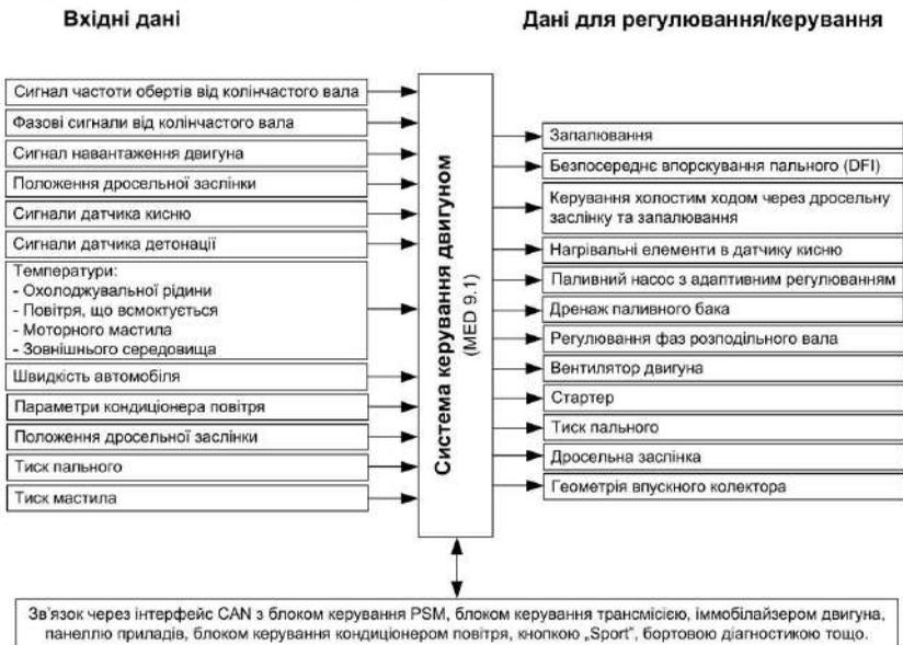
Рисунок 9.8 – Схема інформаційних потоків системи керування двигуном MED 9.1
