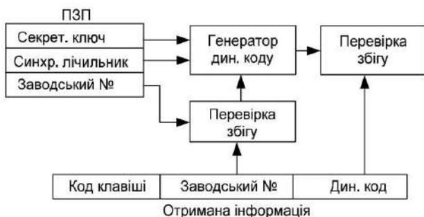
Рисунок 14.4 – Алгоритм роботи приймача
