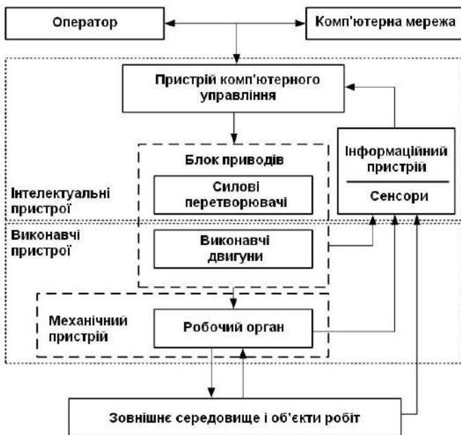
Рисунок 4.1 – Узагальнена схема машини з комп'ютерним управлінням рухом
