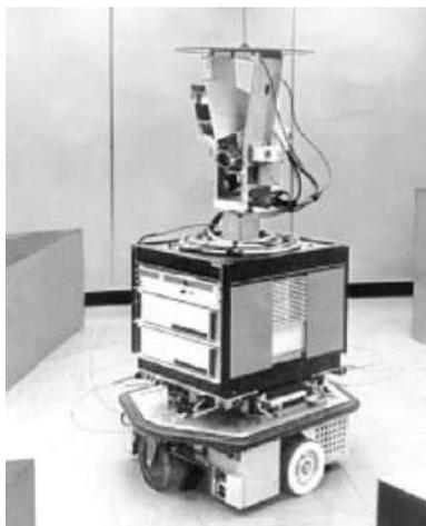
Рисунок 2.17 – Робот Шейки (Shakey)
