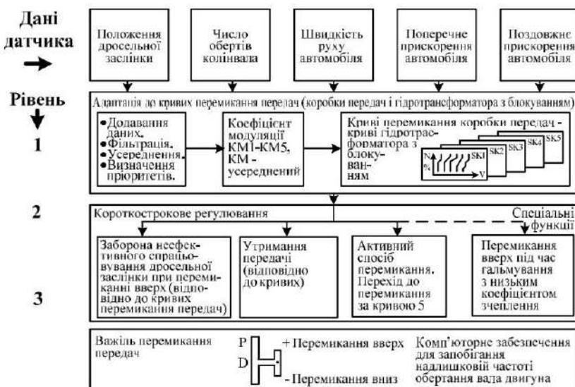
Рисунок 10.4 – Діаграма процесу переключення передач Tiptronic
