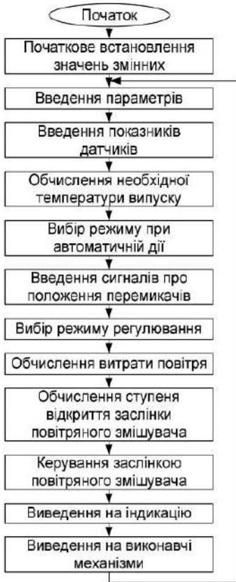
Рисунок 13.11 – Блок-схема алгоритму керування
