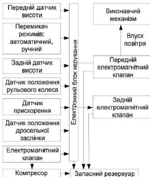
Рисунок 11.12 – Структурна схема керування жорсткістю підвіски автомобіля Toyota
