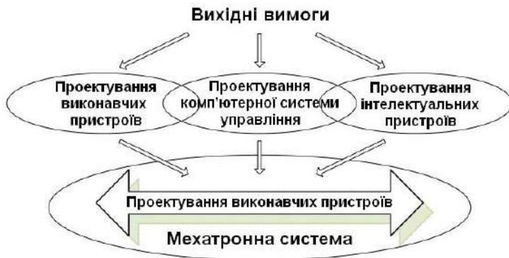
Рисунок 4.5 – Алгоритм паралельного проектування мехатронних систем
