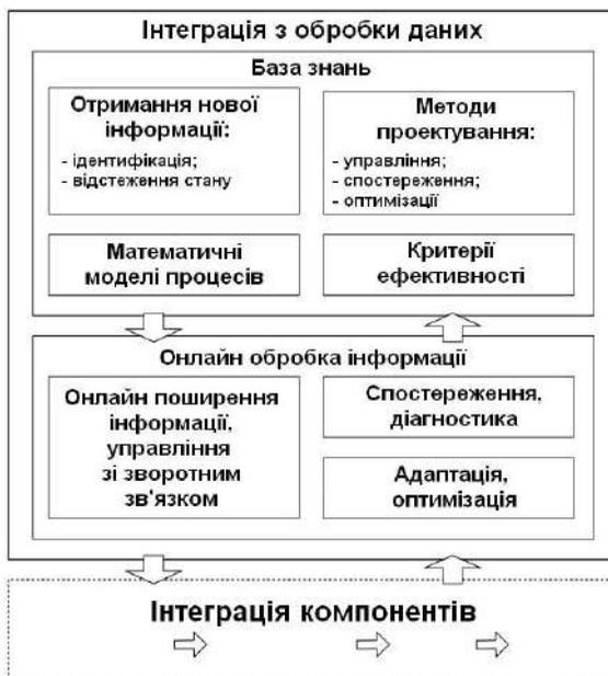
Рисунок 4.2 – Інтеграція складових частин мехатронного пристрою
