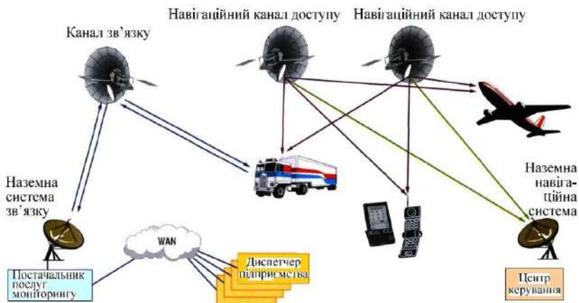
Рисунок 14.10 – Принцип дії супутникової навігації
