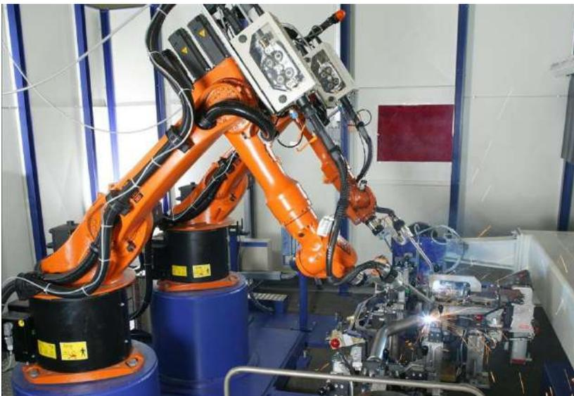
Рисунок 3.5 – Виконання роботом операції зварювання
