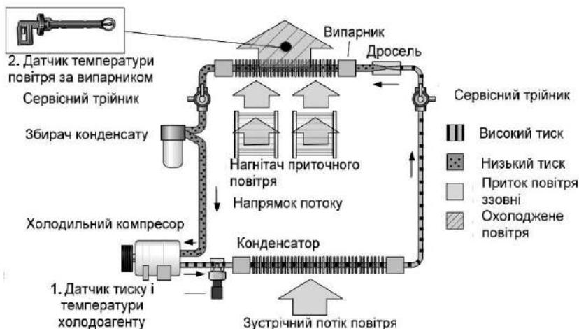
Рисунок 13.4 – Схема циркуляції холодоагенту в холодильному контурі
