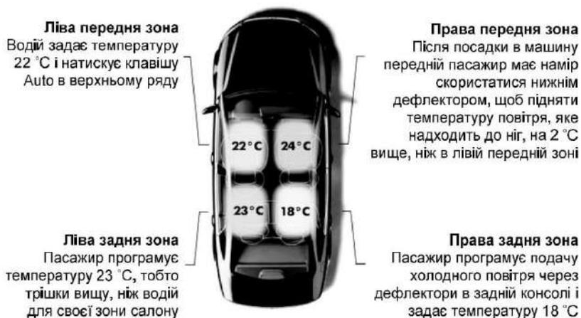
Рисунок 13.12 – Приклад використання принципу чотиризонального регулювання
