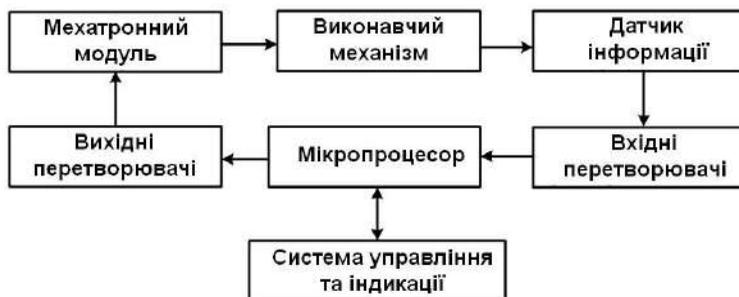
Рисунок 1.2 – Функціональна схема мехатронної системи
