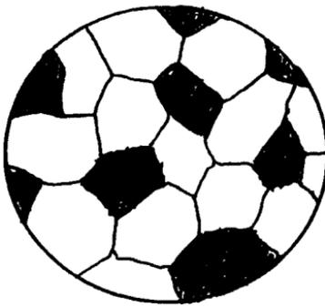
Рис. 1.7. Схема мікроструктури сплаву Pb – Sb
