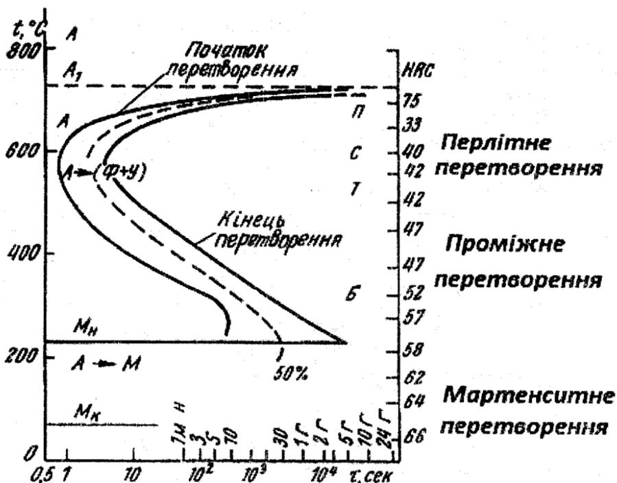
Рис. 1.24. Діаграма ізотермічного розпаду аустеніту вуглецевої сталі У8:
