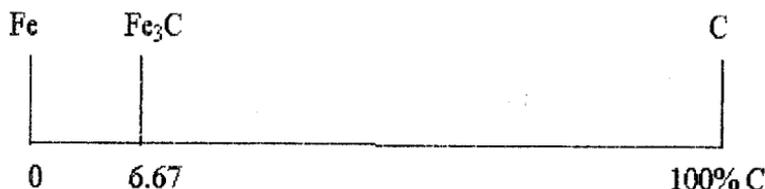
Рис. 1.18. Місце сплавів заліза, що використовуються на практиці, у загальній системі “залізо – вуглець”
