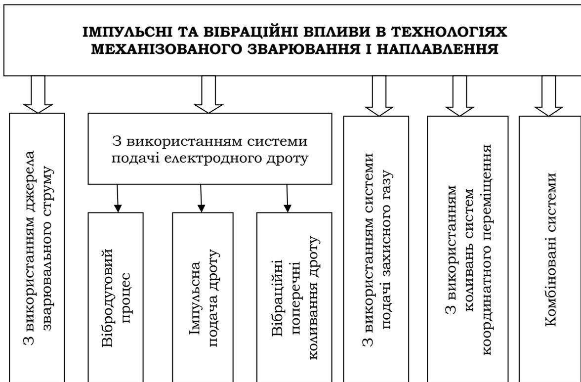
**Рис. 1.1. Використання імпульсних та вібраційних впливів на процеси електродугового зварювання та наплавлення**
