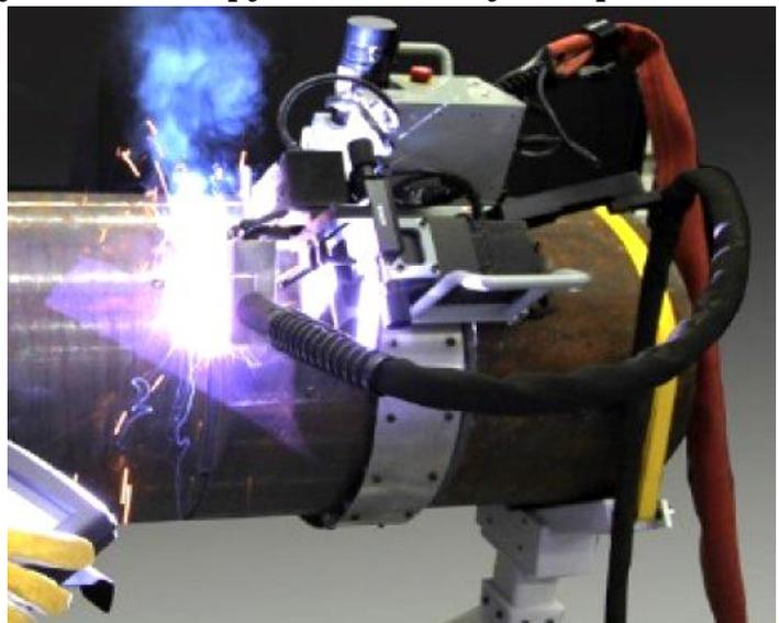
**Рис. 10.25. Автомат для орбітального зварювання з використанням електрода, який плавиться**
