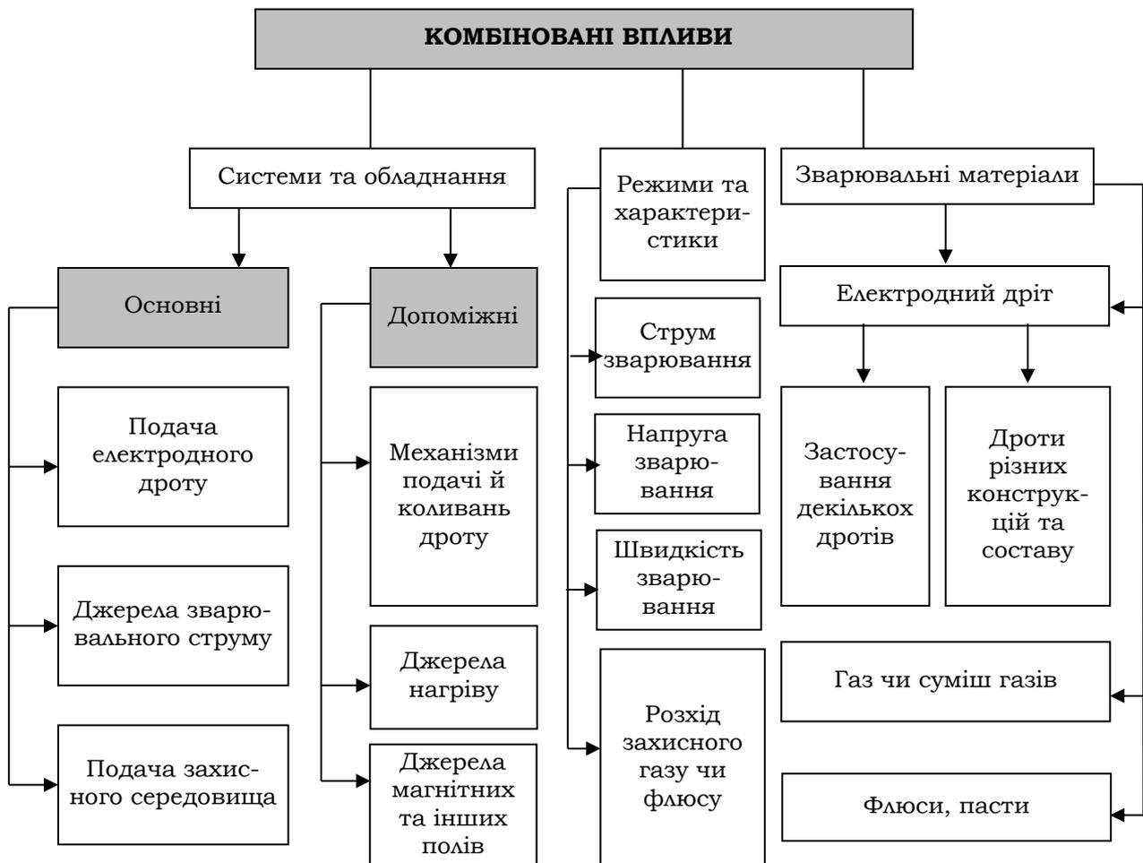
**Рис. 12.1. Впливи для застосування в дуговому механізованому обладнанні**
