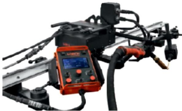
**Рис. 8.17. Транспортний модуль зварювального автомату TRAC RL Performance фірми Lorch**
