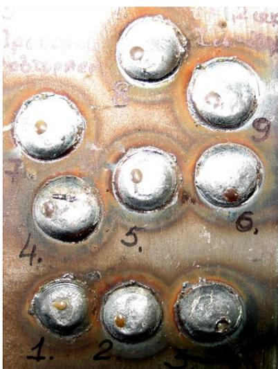
**Рис. 5.11. Ряд точок, отриманих з використанням імпульсної подачі електродного дроту частотою 40 Гц**
