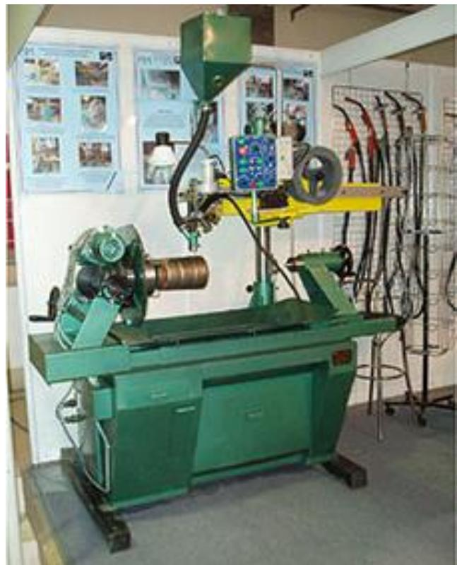
**Рис. 10.15. Станок для наплавлення на базі токарного верстата**
