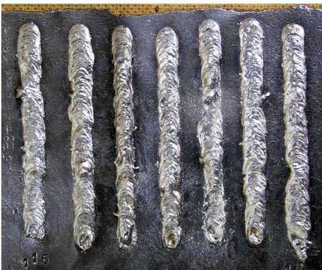
**Рис. 9.3. Валики, напавлені у водному середовищі із застосуванням імпульсної подачі електродного дроту з різними характеристиками - частота, амплітуда, шпаруватість**
