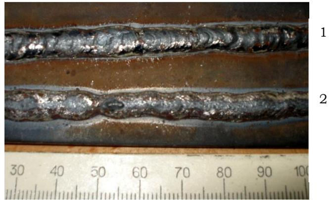
**Рис. 4.15. Результати наплавлення з використанням зварювальних напівавтоматів з механізмами подачі:**
