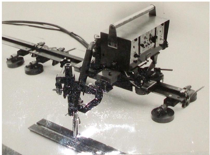
**Рис. 10.4. Пристрій для зварювання в усіх просторових положеннях на магнітних фіксаторах**
