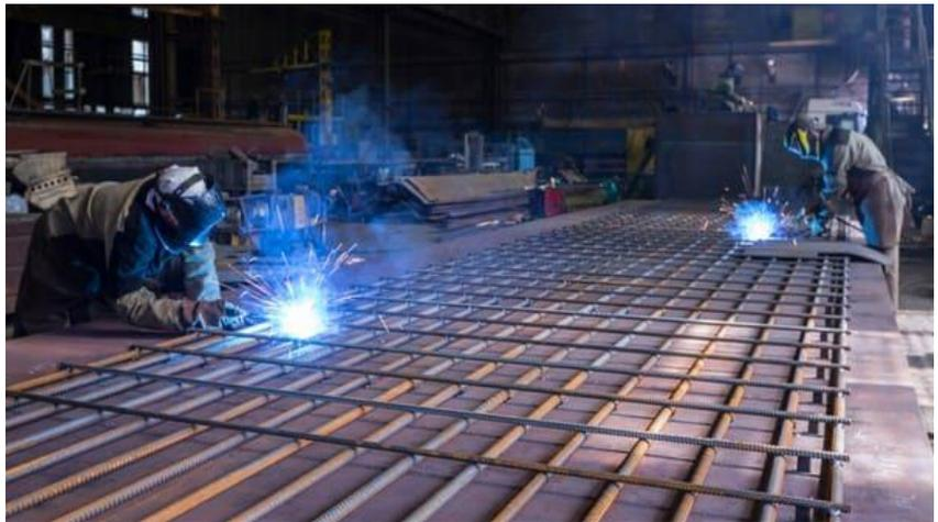
**Рис. 13.2. Робота зварників у нестационарних умовах при виготовленні довгомірних металоконструкцій**
