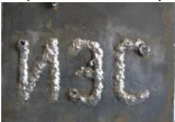
**Рис. 10. 24. Дугове наплавлення автоматично під водою з програмуванням двокоординатного переміщення зварювального інструменту**
