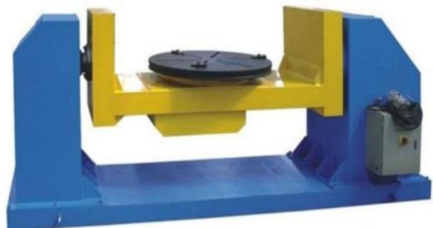
**Рис. 10.10. U-подібний універсальний маніпулятор**
