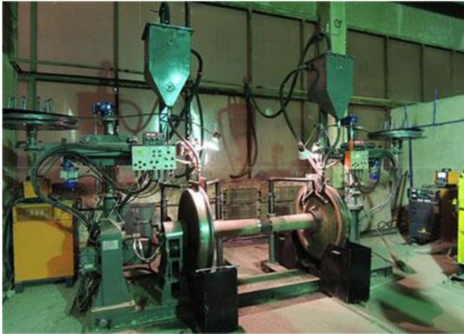
**Рис. 10.16. Установка РМ-9 для наплавлення гребенів залізничних колісних пар**
