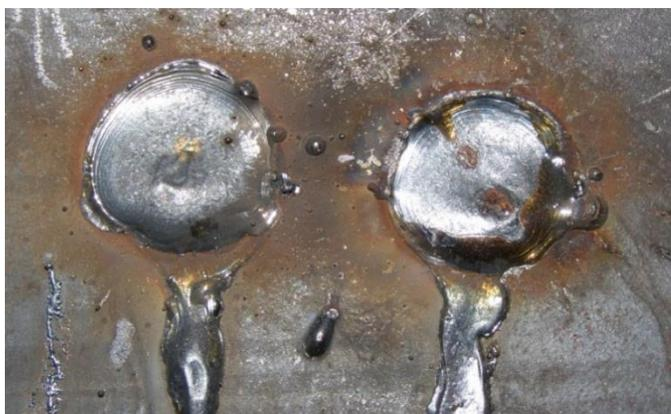
**Рис. 5.8. Дугова точка на вертикальній площині зі стіканням розплавленого металу та неоднаковим формуванням точкового з'єднання**
