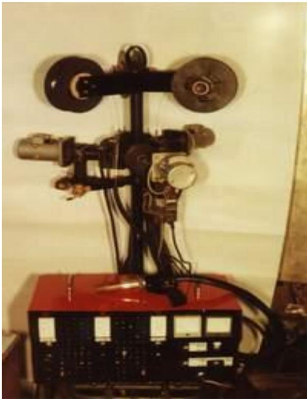
**Рис. 8.23. Система «Триплет» у варіанті для механізованого зварювання**
