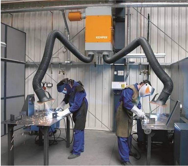
**Рис. 13.1. Робоча кабіна для зварювальників**
