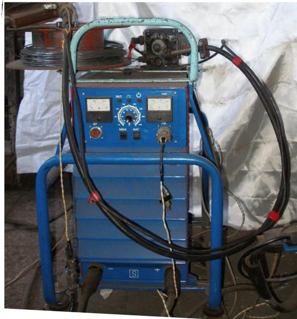
**Рис. 5.5. Мобільний комплекс напівавтомата для відновлювального та зміцнювального наплавлення в місцях зі стисненими умовами роботи**
