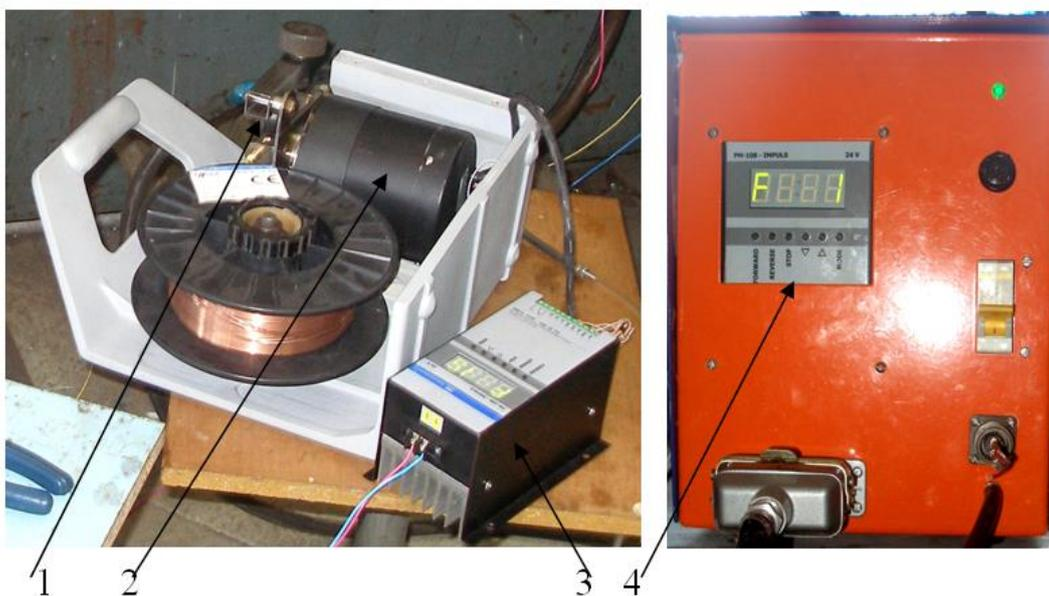
**Рис. 4.12. Механізм імпульсної подачі**
