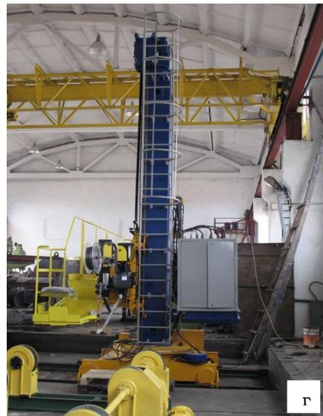
**Рис. 10.29. Комплекси автоматизації та механізації зварювальних процесів із використанням спеціального механічного зварювального обладнання**
