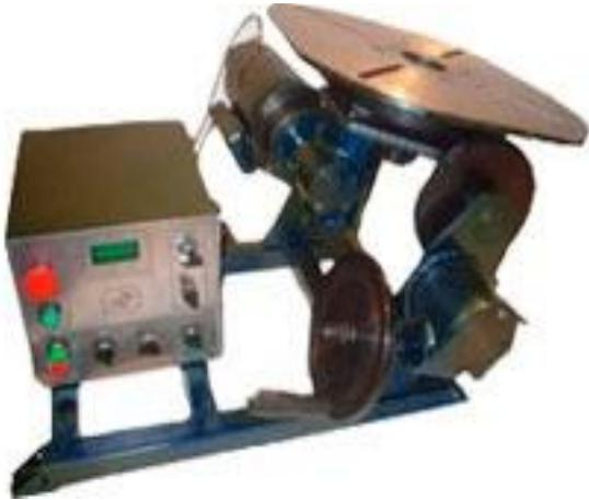
**Рис. 10.7. Малогабаритний універсальний маніпулятор із системою керування і з можливістю обертання та нахилу виробу**
