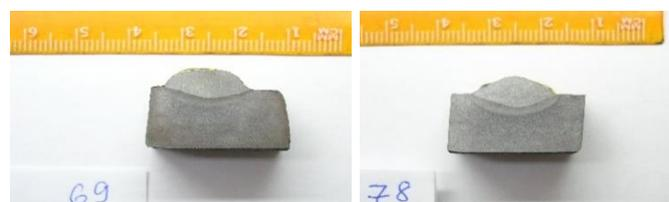
**Рис. 9.16. Макрошліфи валиків з подачею дроту:**
