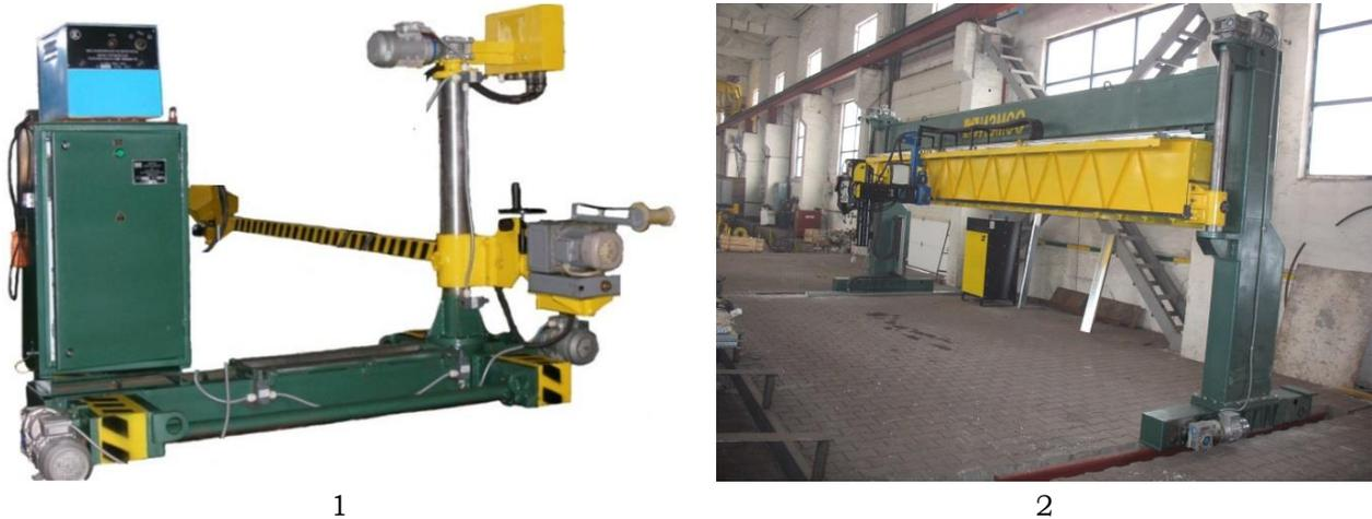
**Рис. 10.13. Унікальні зразки МЗО: пересувний портал (1), установка для напівавтоматичного зварювання під флюсом кільцевих та поздовжніх внутрішніх швів (2)**
