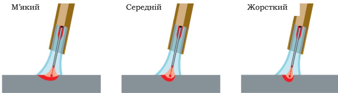
**Рис. 8.13. Динаміка впливу системи Speed на процес зварювання (горіння дуги)**
