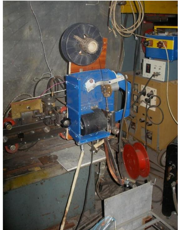
**Рис. 5.9. Стенд для автоматичного зварювання точками на вертикальній площині з імпульсною подачею електродного дроту**
