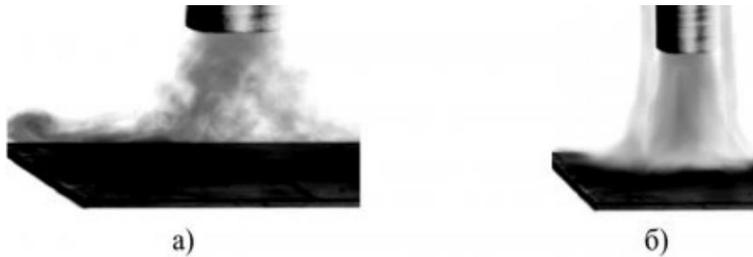
**Рис. 11.5 Газовий захист при зварюванні в захисних газах:**
