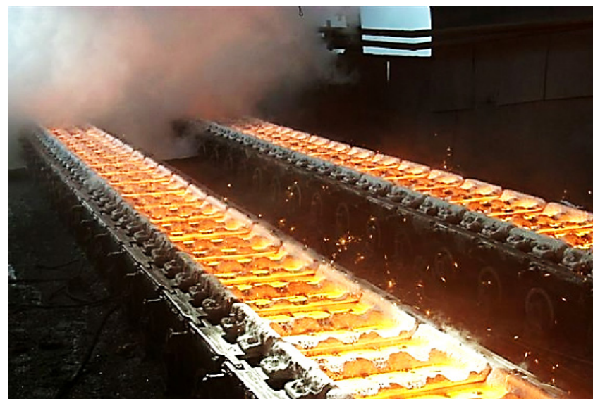
Рисунок 7.5 – Машина для розливки чавуну
