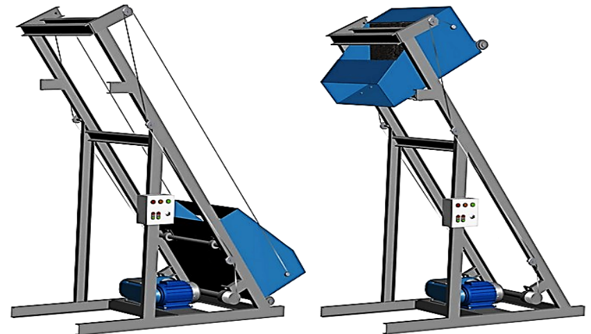
Рисунок 6.5 – Схема роботи скіпового підйомника
