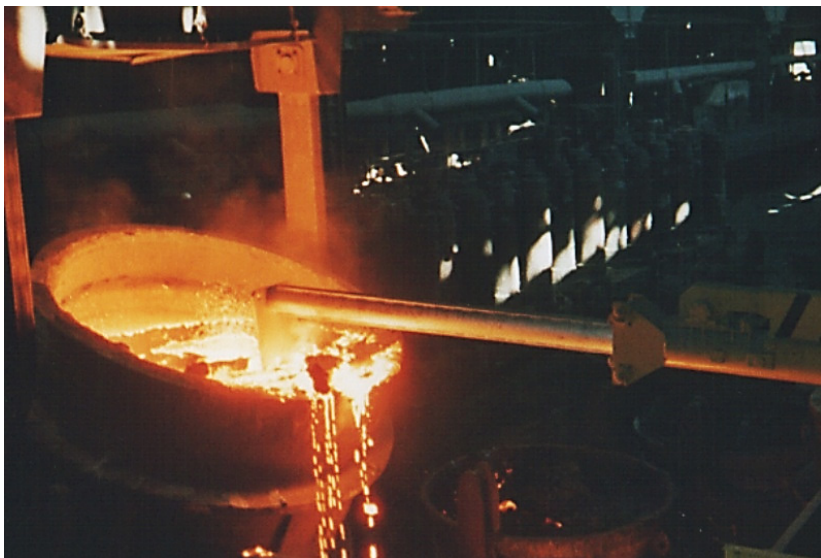
Рисунок 8.3 – Машина для скочування шлаку гребком
