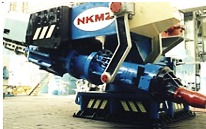
Рисунок 7.2 – Електрогармата для забивання чавунної льотки
