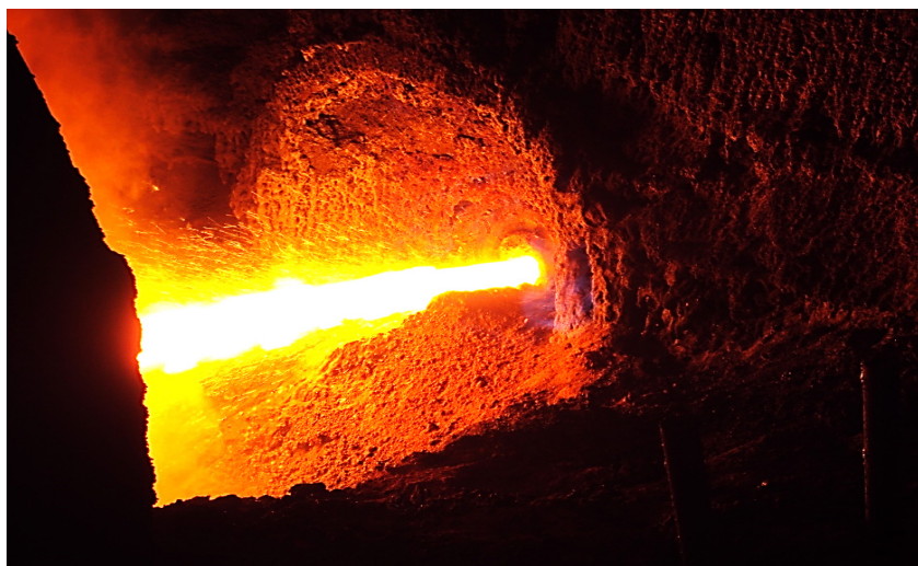
Рисунок 9.6 – Випуск чавуну з льотки доменної печі
