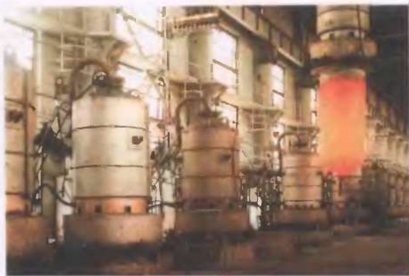
Рисунок 7.28 – Загальний вигляд відділення вакуумної сепарації реакційної маси титану
