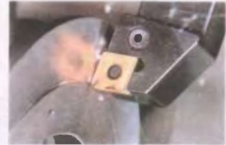
Рисунок 6.7 – Обробка сірого чавуну за допомогою спеціальних сплавів
