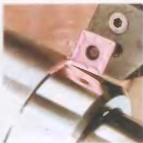
Рисунок 6.10 – Твердосплавний сплав із багат шаровим покриттям
