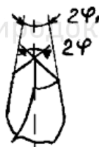
Рис. 114. Подвійне заточування свердла
