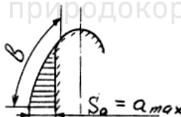
Рис. 79. Переріз зрізуваного шару при криволінійній різальній кромці
