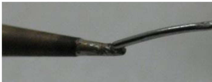
Рисунок 6.10 – На паяльник нанесено занадто багато припою
