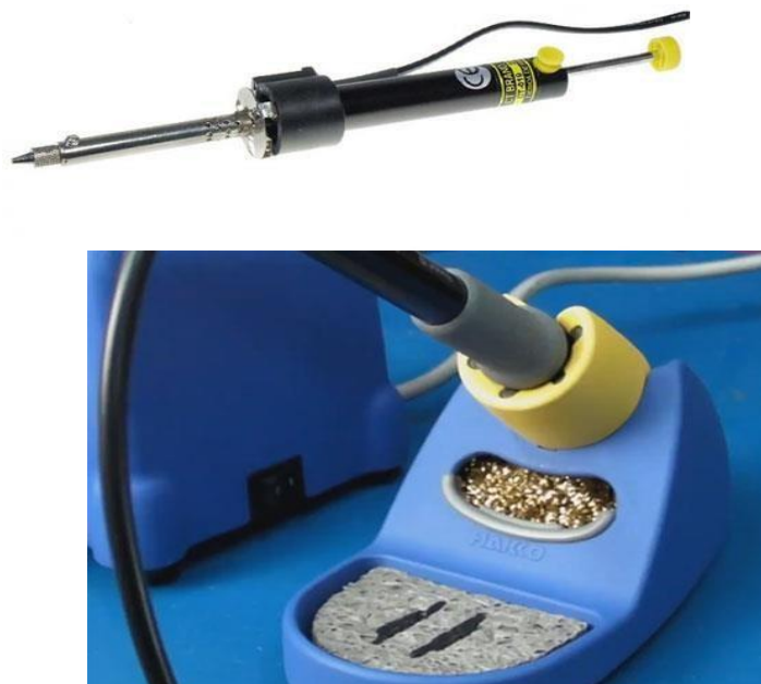
Рисунок 6.7 – Підставка для паяльника з порожниною для металевої стружки Тримач для пайки «Третя рука»
