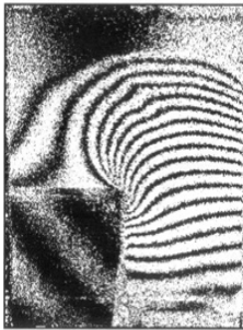
Інтерферограма процесу пресування мідного порошку
