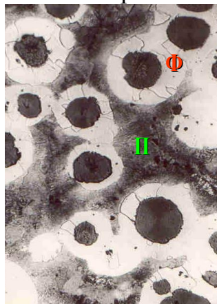
Рисунок 6.9. – Мікроструктура ферито-перлітного високоміцного чавуну
