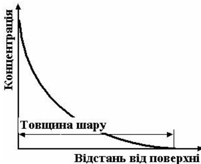
Рисунок 8.4. – Зміна концентрації елементу, що продифундував по глибині металу
