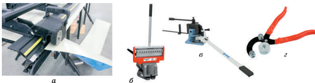
Рис. 4.13. Згинальні верстати та пристрій: а — переносний; б — ручний сегментний листозгинальний; в — ручний; з — ручний універсальний пристрій
