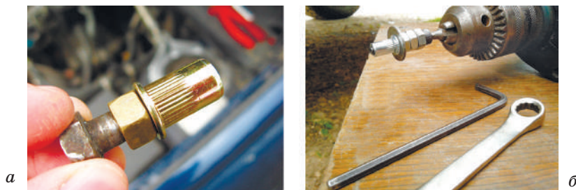
Рис. 7.16. Різьбова заклепка: а — конструкція; б — установа
