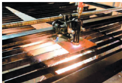
Рис. 10.12. Автоматизоване обладнання для плазмового розкроювання металу
