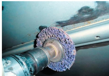
Рис. 14.6. Зачищення шліфувальною машинкою із насадкою (металевою щіткою)
