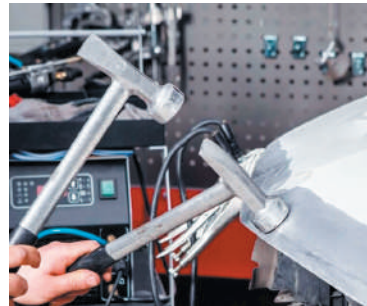
Рис. 14.2. Усунення пошкоджень за допомогою металевих молотків
