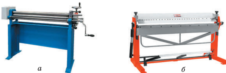
Рис. 4.12. Листозгинальні верстати: а — з валковими елементами; б — з кромкозгинальними елементами
