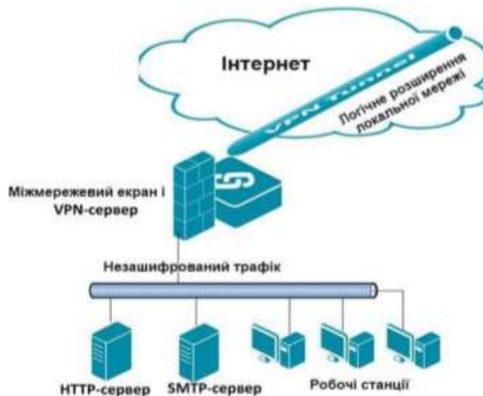
Рис. 12.10. VPN й екстранет, що з'єднує дві інтранет мережі Джерело: [2-4]
