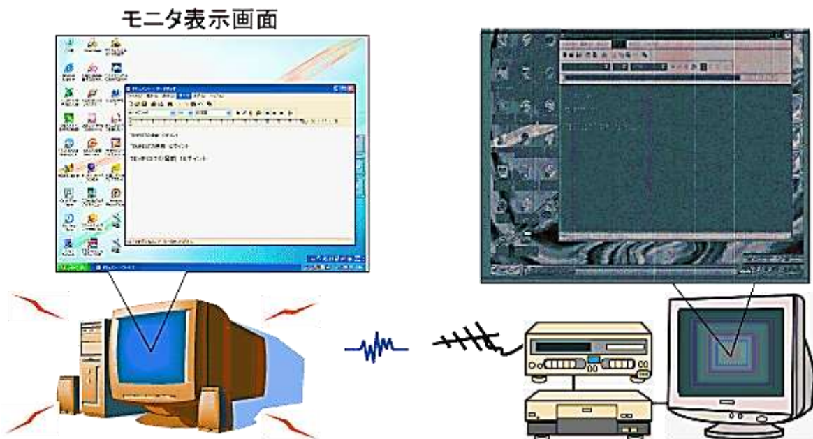
Рис. 8.3. TEMPEST-атака (можна віддалено проглядати екран вашого комп'ютера і мобільного телефона за допомогою радіохвиль)
