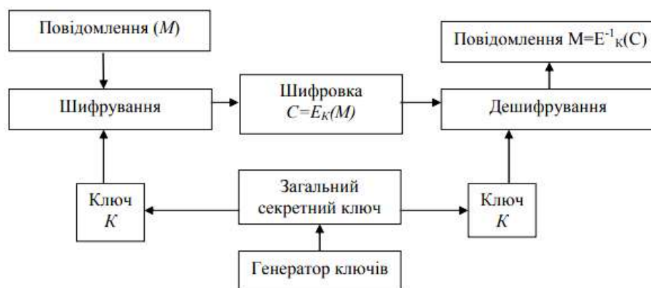
Рис. 18.1. Використання симетричного методу шифрування Джерело: побудовано автором на основі [8-9]
