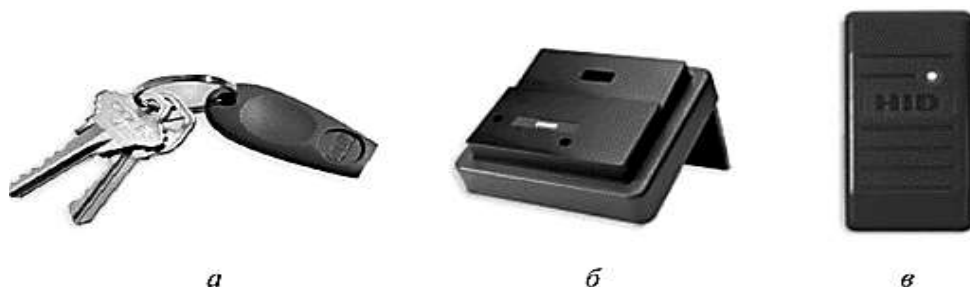
Рис. 10.2. RFID-брелок (а), програматор (б) та пристрій для читання (в) Джерело: [1-7]
