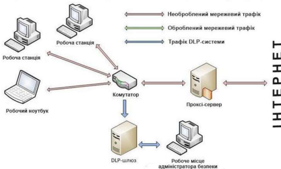
Рис. 28.4. Шлюзова DLP-системи, що працює в режимі моніторингу Джерело: [2]
