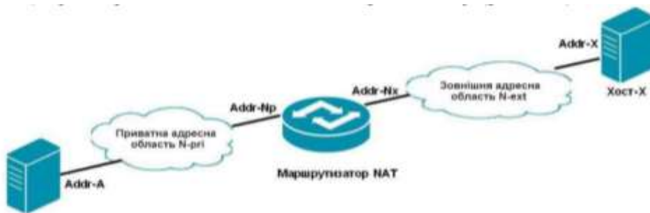
Рис. 12.6. Схема розташування міжмережевого екрану з можливостями NAT
