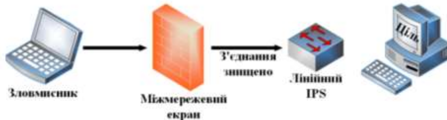
Рис. 12.18. Система запобігання вторгнень (IPS)
