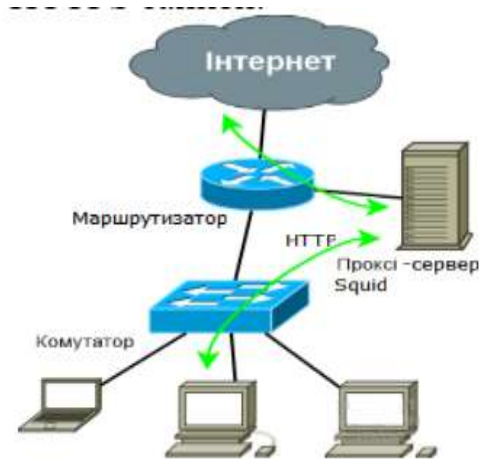
Рис. 12.13. Прозорий режим роботи проксі серверу Джерело: [2-4]
