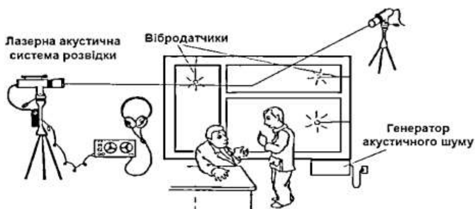
Рис. 8.6. Створення віброакустичних завад лазерній системі розвідки Джерело: [1-7]
