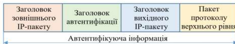
Рис. 14.17. Структура IP-паketу, обробленого протоколом АН в тунельному режимі
