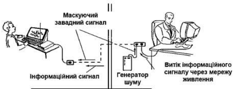
Рис. 8.7. Зашумлення ліній електроживлення Джерело: [1-7]
