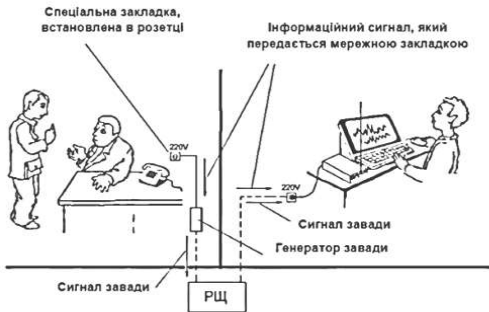
Рис. 8.8. Зашумлення сторонніх провідників і сполучних ліній Джерело: [1-7]
