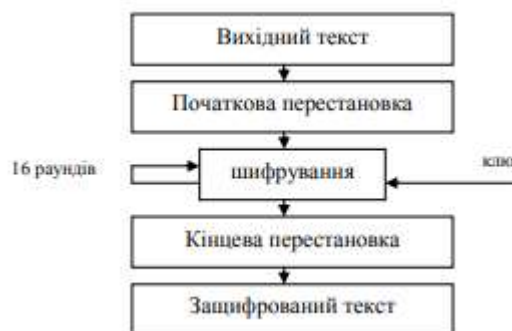
Рис. 19.1. Узагальнена схема шифрування в алгоритмі DES Джерело: [8-9]
