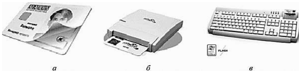
Рис. 10.3. Смарт-картка (а) і пристрій для читання (б, в) Джерело: [1-7]
