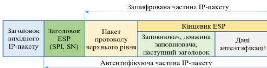
Рис. 14.18. Структура IP-паketу, обробленого протоколом ESP в транспортному режимі
