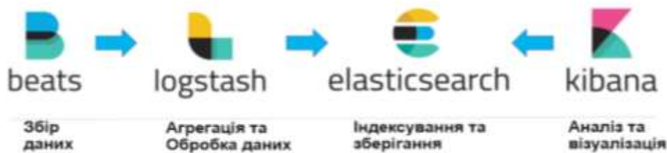
Рис. 28.7. Узагальнена схема роботи стека ELK
