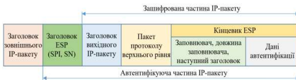
Рис. 14.19. Структура IP-пакету, обробленого протоколом ESP в тунельному режимі
