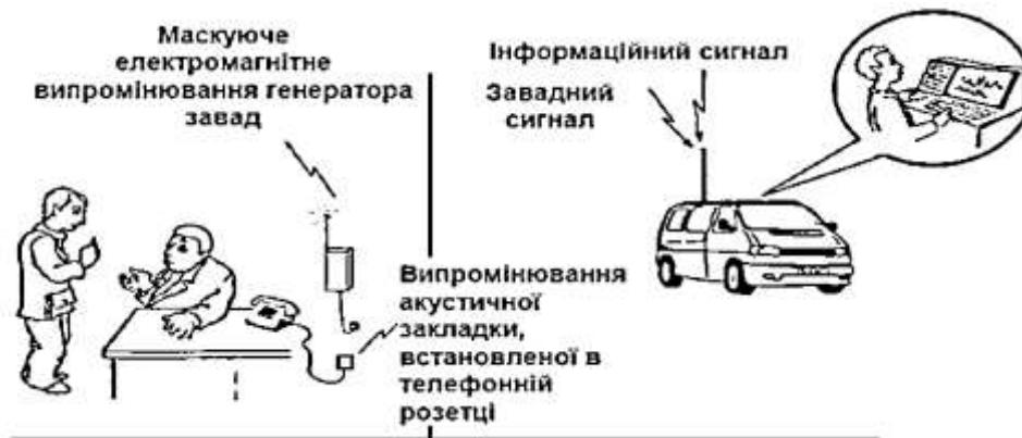
Рис. 8.5. Електромагнітне зашумлення телефонної закладки Джерело: [1-7]
