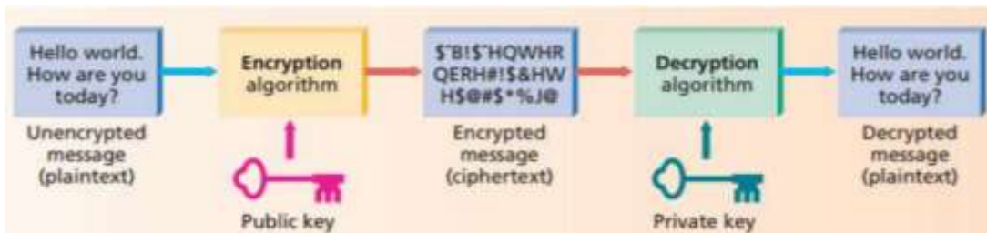
Рис. 14.4. Шифрування з використанням асиметричних (несиметричних, з відкритим ключем) алгоритмів
