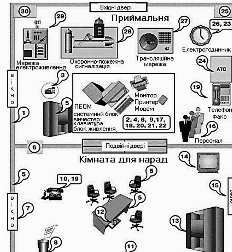
Рис. 19.1. Узагальнена схема можливих каналів витоку та несанкціонованого доступу до інформації, оброблюваної в типовому одноповерховому офісі
