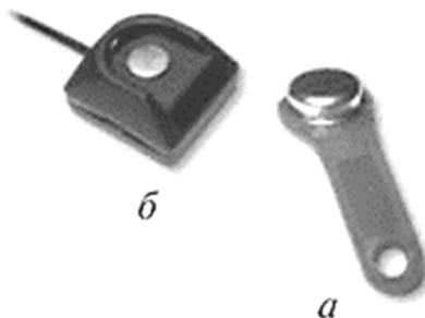
Рис. 21.2. Елемент (а) та пристрій для читання TouchMemory (б)
