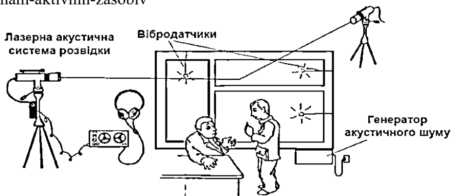
Рис. 19.6. Створення віброакустичних завад лазерній системі розвідки
