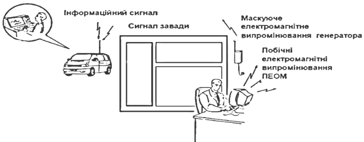
Рис. 19.4. Просторове електромагнітне зашумлення комп'ютерного місця
