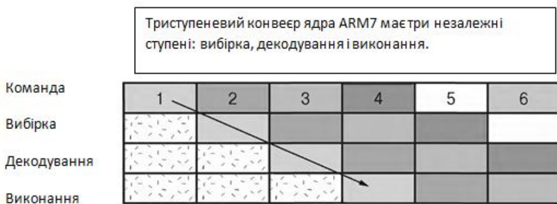
Рисунок 3.1 – Робота триступеневого конвеєра
