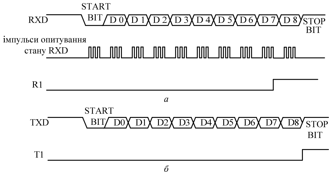
Рисунок 3.21 - Часові діаграми роботи послідовного інтерфейсу в режимі 2: а - прийом байта; б - передача байта
