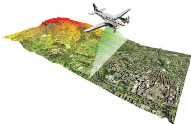
Рис. 8.15. Схематичне зображення процесу дистанційного знімання за допомогою лідарів
