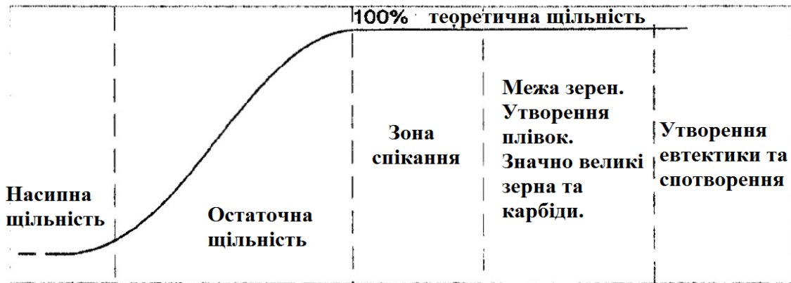
Рисунок 1 - Загальна характеристика процесу спікання швидкорізальних порошкових сталей в інтервалі температур солідус-ліквідус (залежність щільності від температури спікання).
