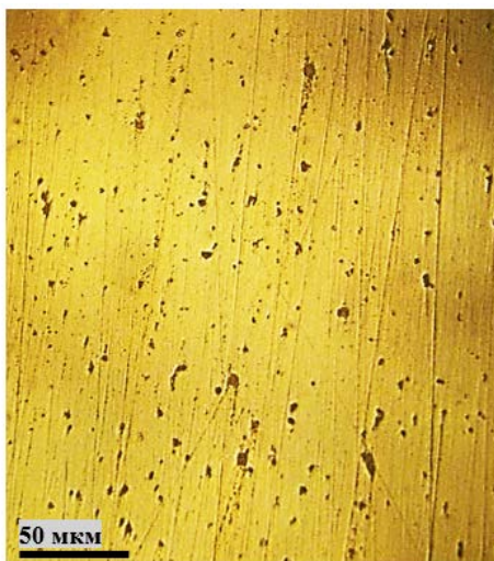
Рис. 4 – Вкраплення мікросуспензії у сплаві міді з 4,8 % карбонільного заліза, перегрітого на 120 K над лінією ліквідус (травлено).
