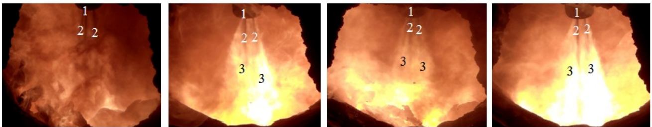
Рис.4- Характер поширення паливно-кисневих струменів під час нагріву металобрухту:
