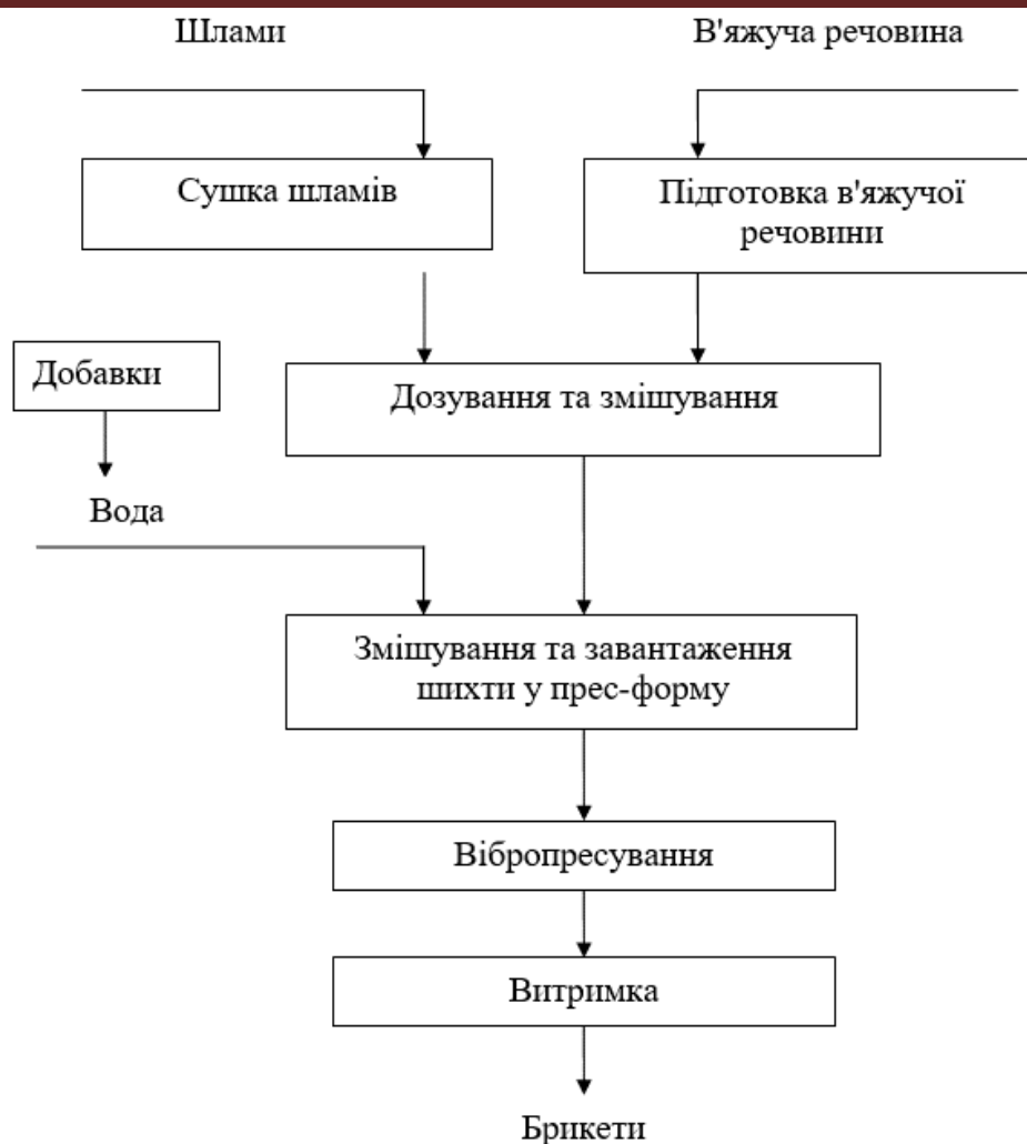
Рис.1 - Принципова технологічна схема виробництва брикетів методом вібропресування
