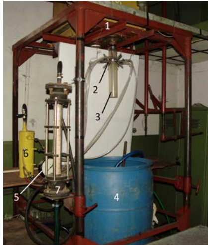
Рис. 1 – Лабораторна установка холодного моделювання випуску розплаву з конвертера: 1 – ємність з рідиною; 2 – продувний блок; 3 – випускний канал; 4 – приймальний ківш; 5 – манометр; 6 – колектор; 7 – ротаметр
