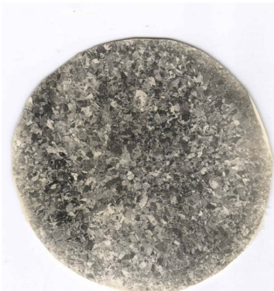
Рис.2. Макроструктура зливку титано-вого сплаву ВТ-5Л, виплавленого в дуговій печі з витрачаємим електродом.
