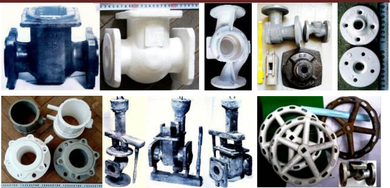
Рис. 1 – Моделі та виливки деталей трубої арматури з ливарного цеху ФТІМС НАНУ
