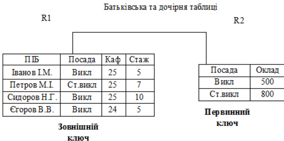
Рисунок 13.1 - Зв'язок відношень за допомогою зовнішнього ключа
