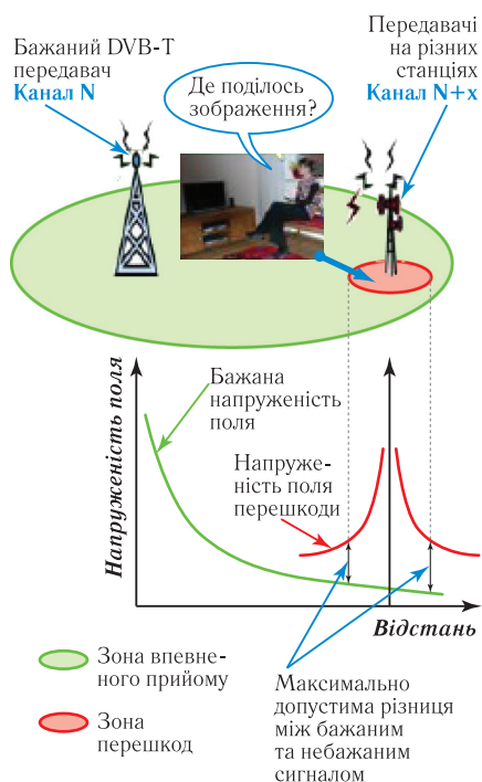
Рис. 5.31 Передавачі на різних передавальних станціях
