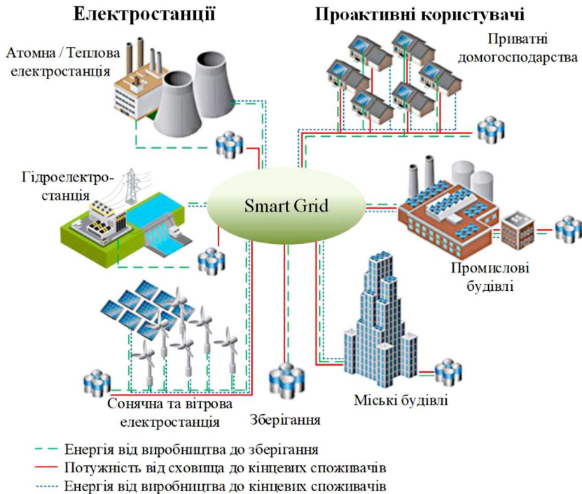
Рис. 1. Інфраструктура Smart Grid із проактивним виробником і споживачем енергії
