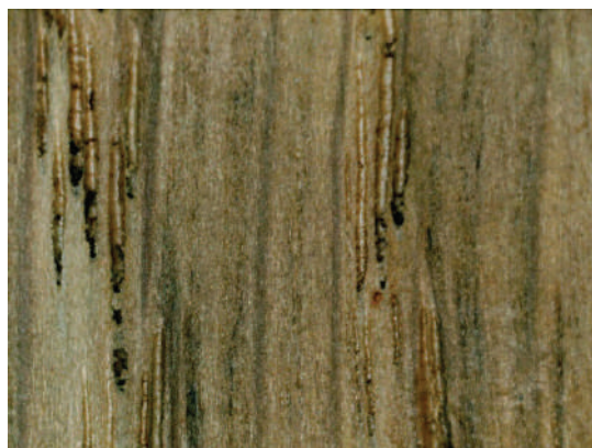
Іл. 5. Макрофотографія деревини дуба (збільшення x50), поперечний розпил (ліворуч) та тангенційний розпил (праворуч)
