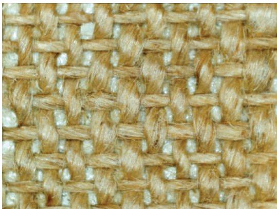
Лл. 12. Макрофотографія полотна простого прямого переплетення (збільшення x50)
