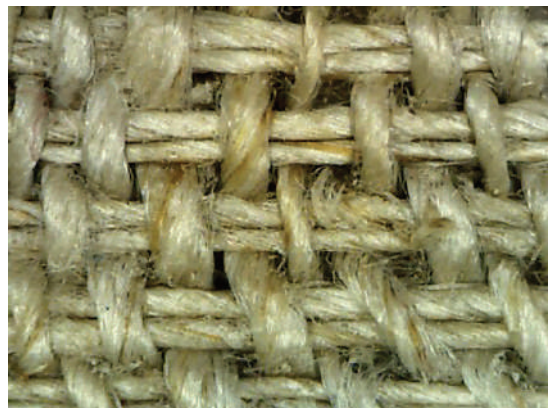
Лл. 13. Макрофотографія полотна складного прямого переплетення (репс) (збільшення x50)
