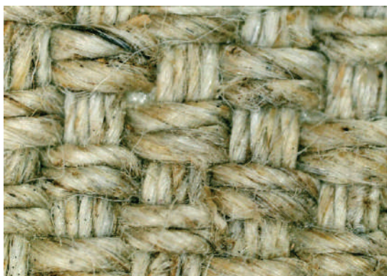
Іл. 14. Макрофотографія полотна складного прямого переплетення (рогожка) (збільшення \times 50 )
