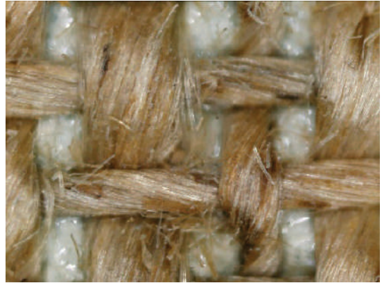
Лл.9. Макрофотографія полотна з лляного волокна (збільшення x50)
