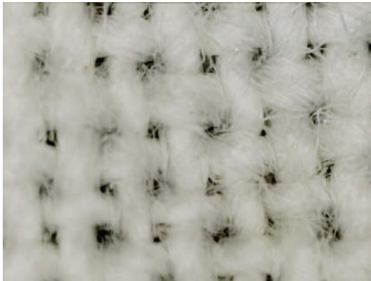
Лл. 10. Макрофотографія полотна з бавовняного волокна (збільшення x250)
