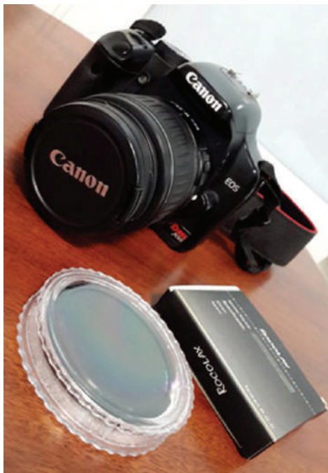
Іл. 52. Модифікований для зйомки в ІЧ діапазоні фотоапарат, обладнаний фільтром
