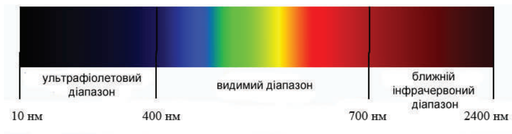
Іл. 1. Області спектру електромагнітних хвиль ультрафіолетового, видимого і інфрачервоного діапазонів
