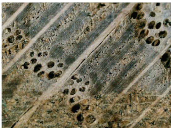
Іл. 5. Макрофотографія деревини дуба (збільшення x50), поперечний розпил (ліворуч) та тангенційний розпил (праворуч)
