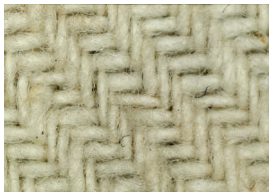
Іл. 15. Макрофотографія полотна діагонального (саржевого) переплетення (збільшення \times 50 )
