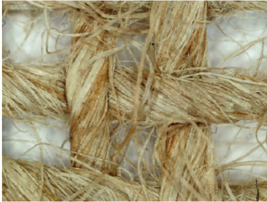
Лл. 8. Макрофотографія полотна з конопляного волокна (збільшення x50)
