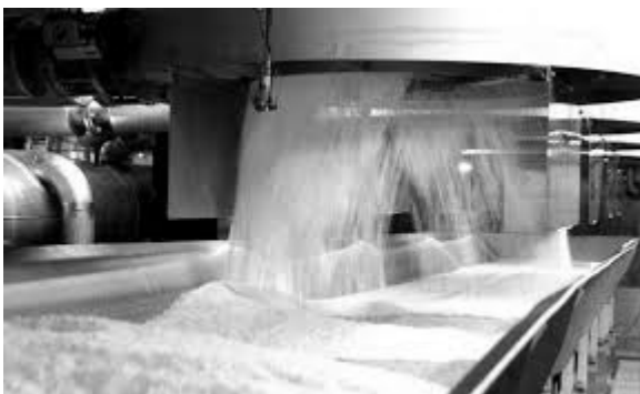
Рисунок 14.4 – Відділення грудок і розсіювання на фракції у сортувальній машині
