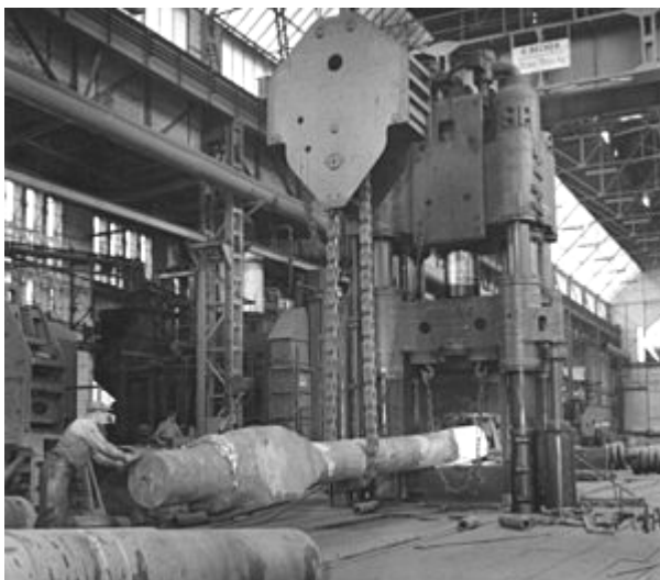
Рисунок 8.12 – Кування великої заготовки
