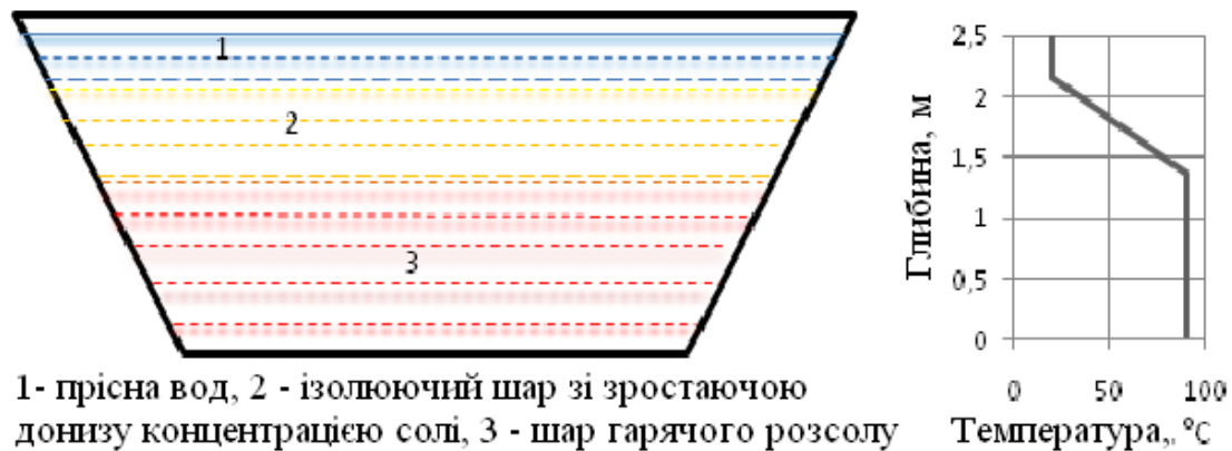
Рис. 1.2. Схема сонячного соляного ставка і зміна температури рідини по глибині ставка
