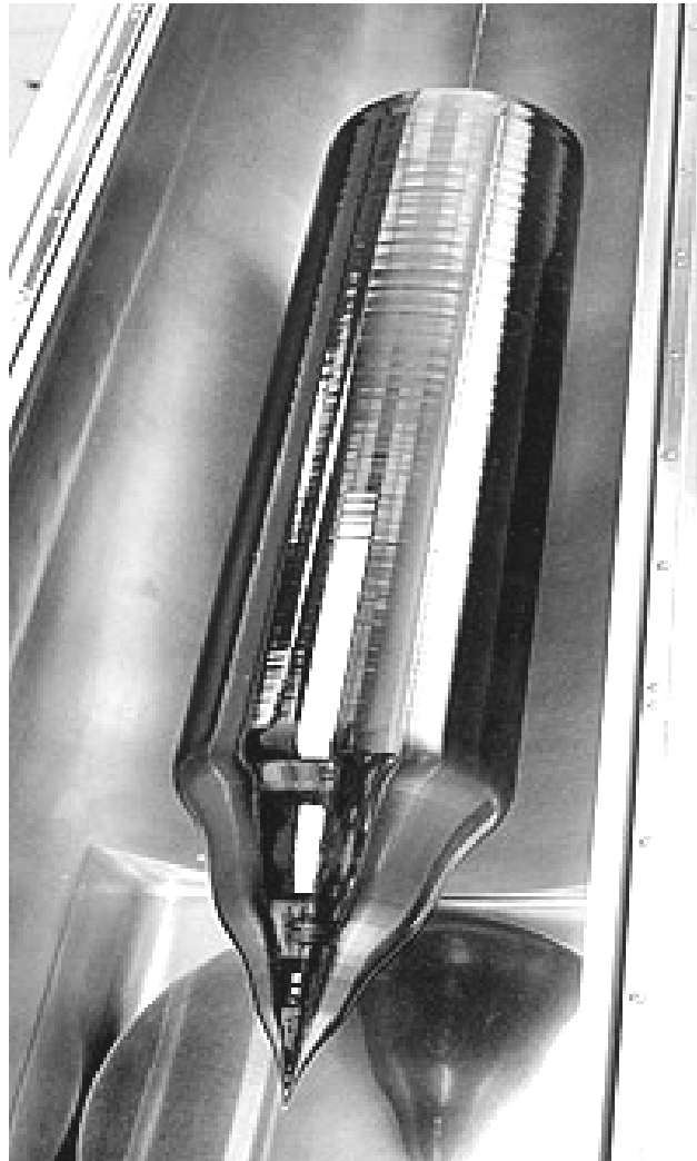
Рис. 2.4. Монокристал, вирощений за методом Чохральського.
