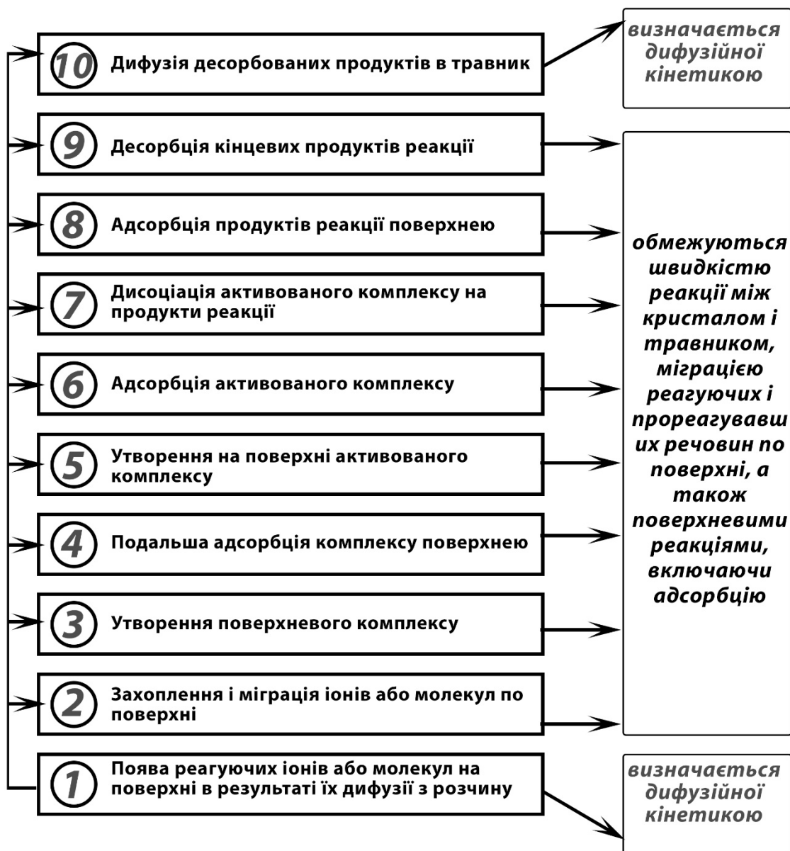
Рис. 5.2. Етапи розчинення кристалу при електрохімічній обробці
